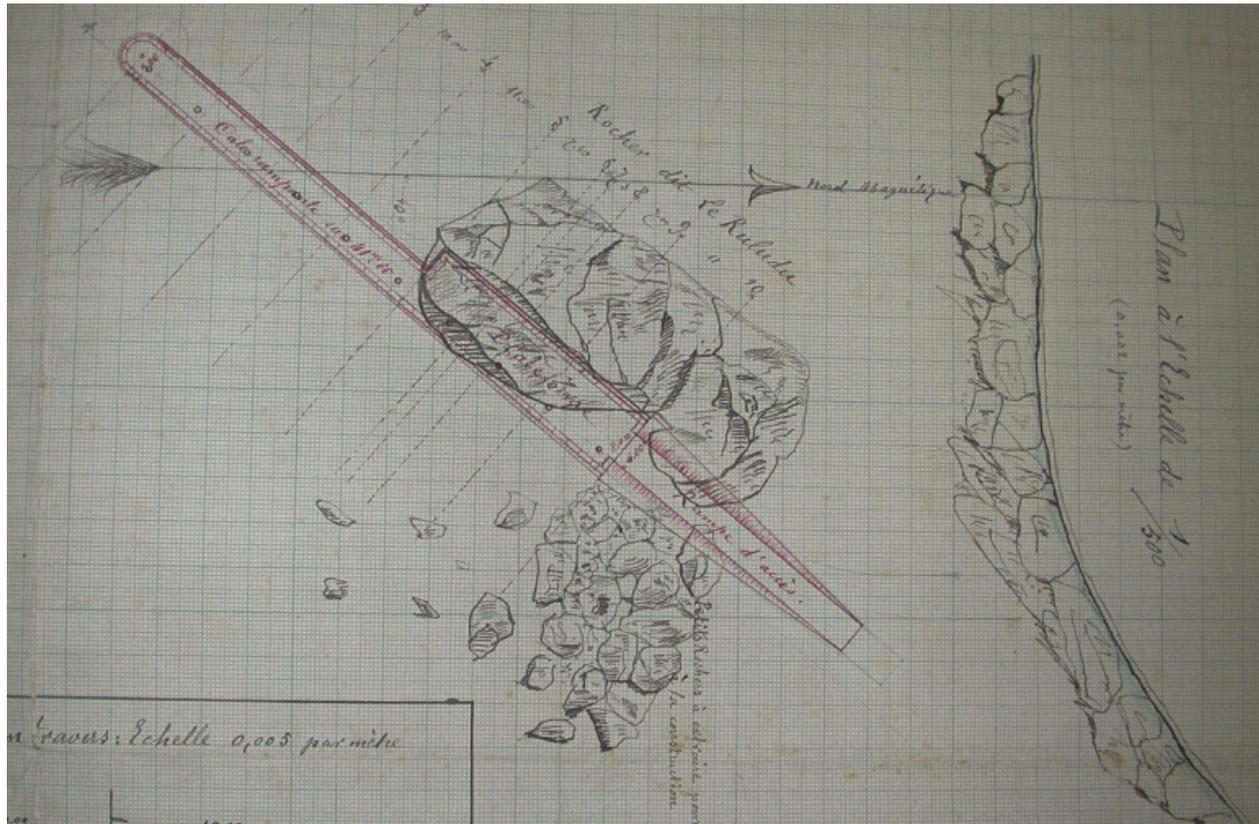
Plan du rocher du Ruludu avec les ouvrages projetés : cale rampante, plateforme et rampe d'accès, 1886 (AD 22)
