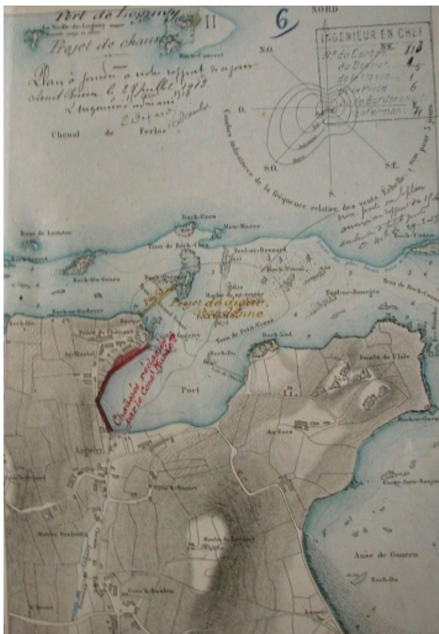
Plan général du port de Loguivy en 1913 : chaussée et rampes d'accès projetées, projet de digue abandonné (AD 22)
