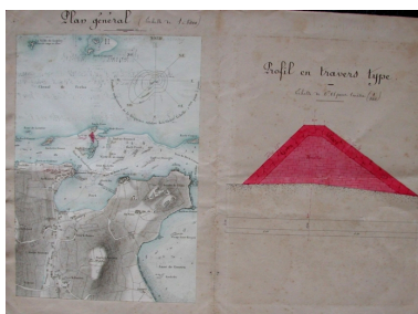
Plan du port de Loguivy en 1890 et profil de travers de la digue projetée (AD 22) Phot. Guy Prigent, Phot. Charles Marie Guillemoto, Autr. Charles Marie Guillemoto IVR53_20082207087NUCB
