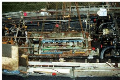
Vue du sous-marin Agosta en grand carénage : dépose et treuillage du moteur diesel par une brèche dans la coque, photographie non datée (1991-1992 ?)
