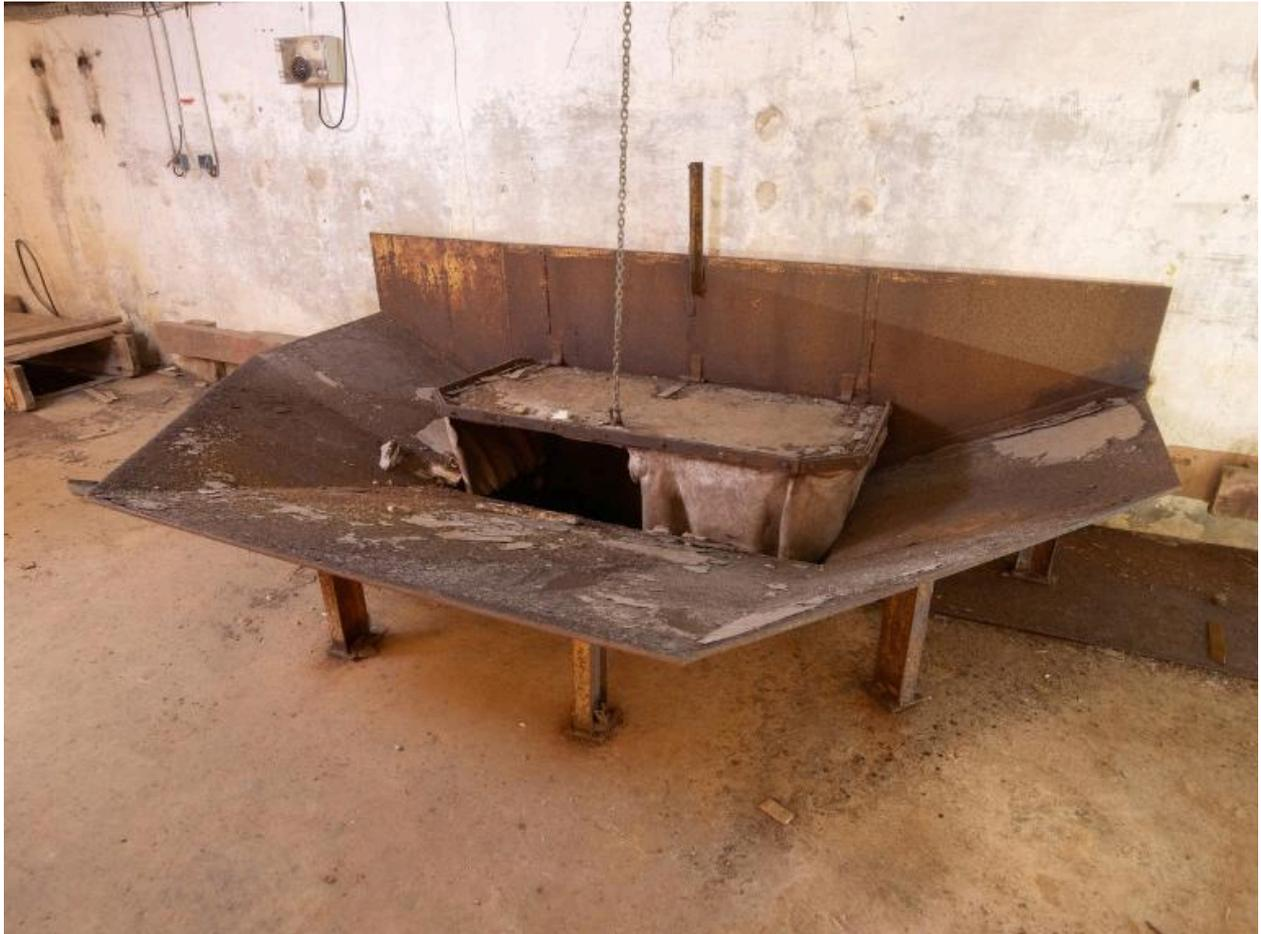
Frigorifique de Lorient : 3e étage, antichambre, broyeur : les pains de glace extraits des mouleaux y étaient déposés manuellement.
