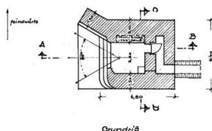
Plan-type d'un bunker de type 667
