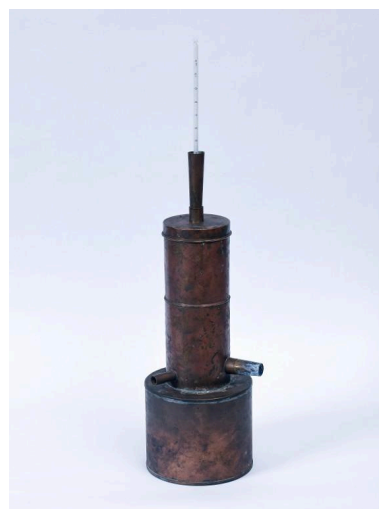
Appareil de Regnault pour déterminer le degré 100 du thermomètre. Phot. Bègne Bernard IVR53_20242900121NUCA
