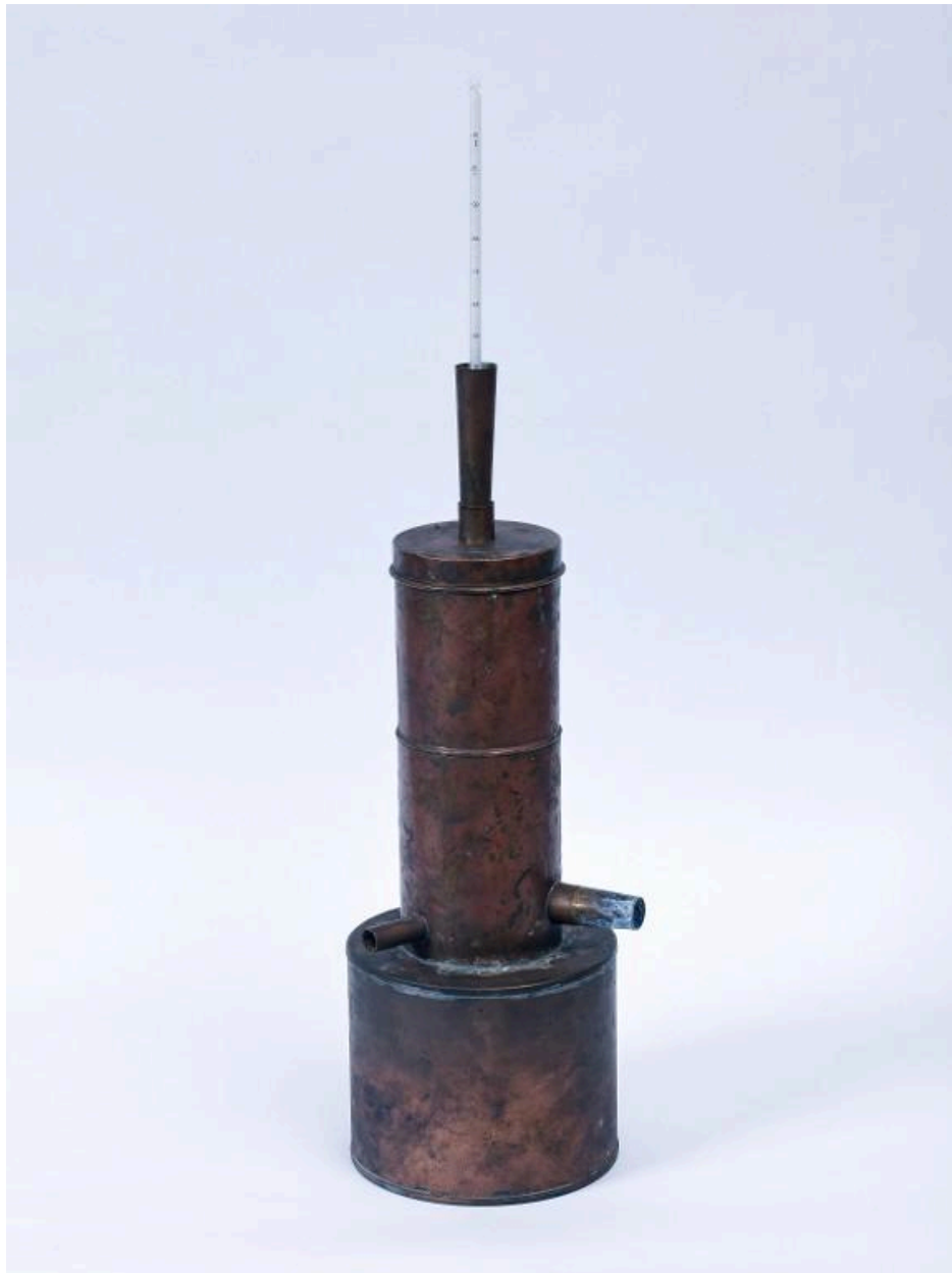
Appareil de Regnault pour déterminer le degré 100 du thermomètre.
