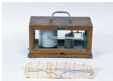
Baromètre enregistreur (Maxant Paris). Sur le graphique, on aperçoit la dépression qui a causé l'ouragan de 1987. Phot. Bègne Bernard IVR53_20242900123NUCA
