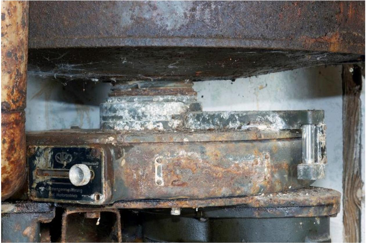
Vue de détail du ventilateur (modèle HES de 2,4 m3 pouvant fonctionner avec deux manivelles)
