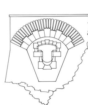
Elévation de l'une des deux embrasures de la batterie de rupture de l'îlot des Capucins
