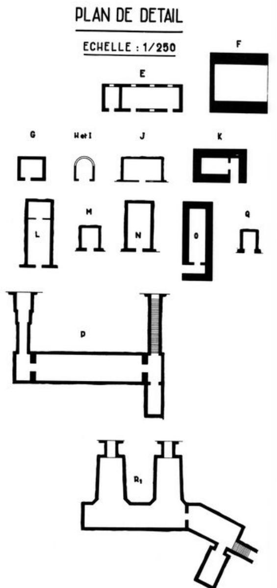
Plan de détail des ouvrages des batteries de la pointe des Capucins (batterie de rupture : repère R1)
