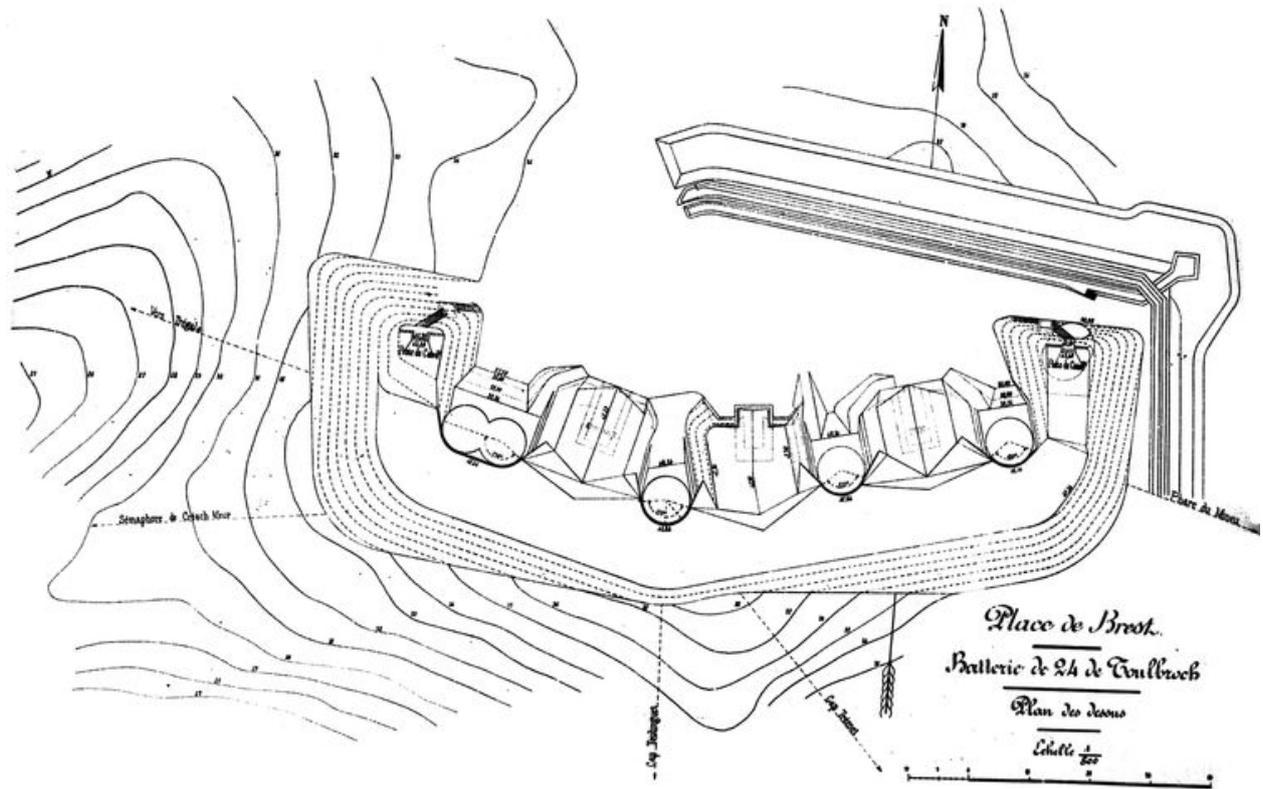
Plan de la batterie de Gauche de 24 cm (4 canons de 24 cm modèle 1870 sur affûts M modèle 1883 PC)
