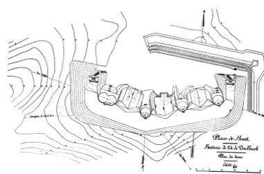
Plan de la batterie de Gauche de 24 cm (4 canons de 24 cm modèle 1870 sur affûts M modèle 1883 PC)
