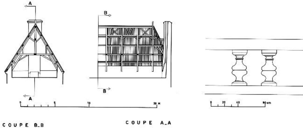
Coupes transversale et longitudinale sur les combles et détail balustres
