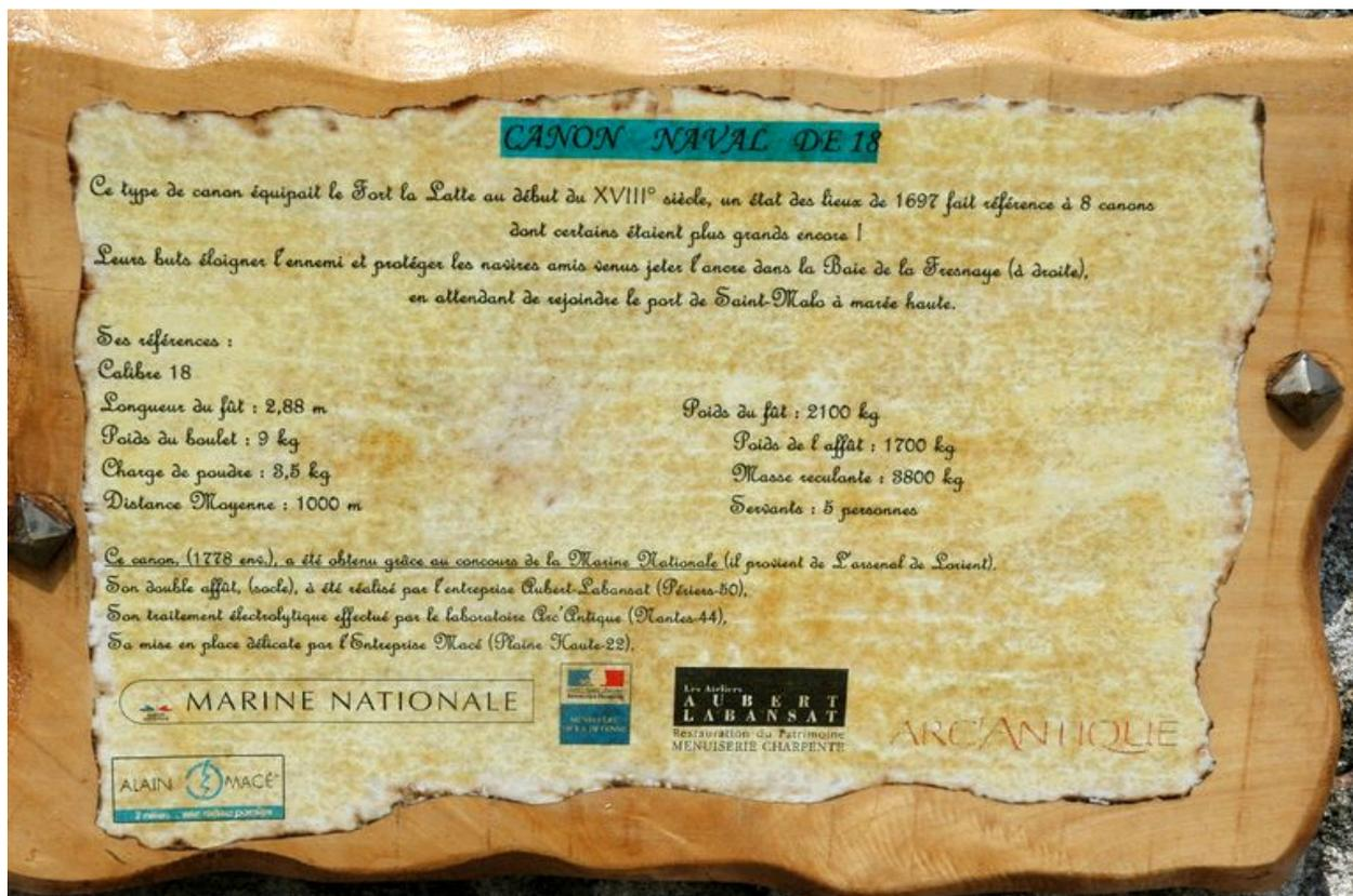
Vue du Fort La Latte : reconstitution d'un canon sur affût à châssis pivotant type Gribeauval. Signalétique en place : canon de 18 livres de balle, 2,88 m de longueur, 2100 kg (tube), 1700 kg (affût)
