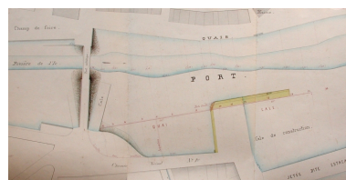
Plan : cale refaite et mur de quai en amont écroulé sur 121 m, projet de construction d'un nouveau quai, 1876-77 (AD 22) Phot. Guy Prigent, Phot. Pelaud, Phot. Jourjon, Autr. Pelaud et Jourjon IVR53_20072206062NUCB
