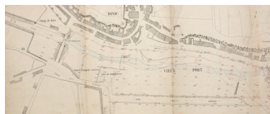
Plan coté du vieux port de Binic, daté du 15 novembre 1906 : remarquer les quais, l'ancien pont métallique, le dépôt d'engrais marins, la vieille cale de construction, la cale de la cloche (AD 22) Phot. Guy Prigent, Phot. Auteur inconnu IVR53_20072206352NUCB
