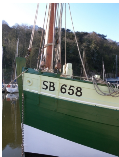
Vue de l'étrave à moustaches du 'Grand Léjon' : remarquer le haut franc-bord Phot. Guy Prigent IVR53_20082213348NUCA
