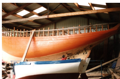
Opération de calfatage du Grand Léjon par Serge Riou, charpentier de marine (collection particulière, Association le Grand Léjon) Repro. Guy Prigent, Autr. Stéphanie (auteur) Huet IVR53_20082213356NUCB
