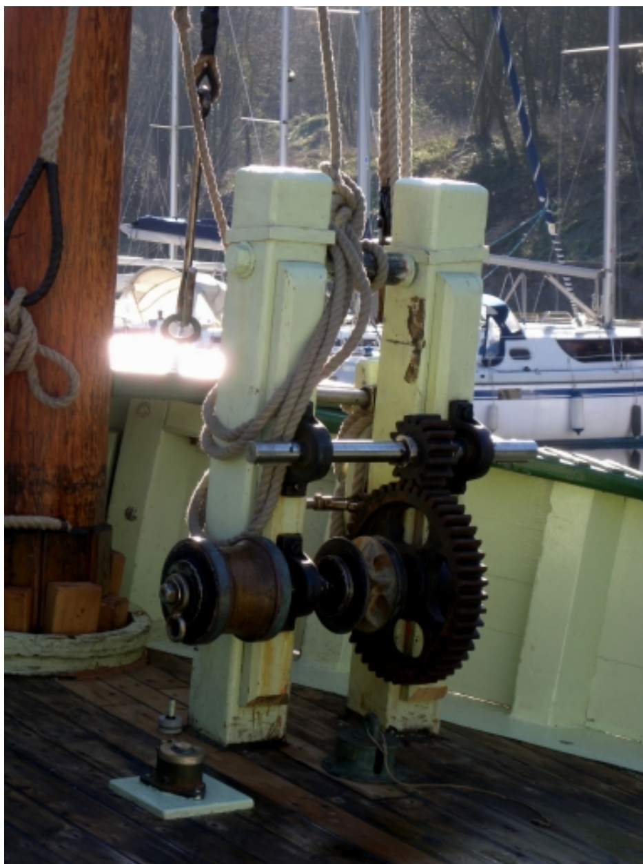
Vue du guindeau reconstitué sur le pont avant, avec les deux pignons et le barbotin
