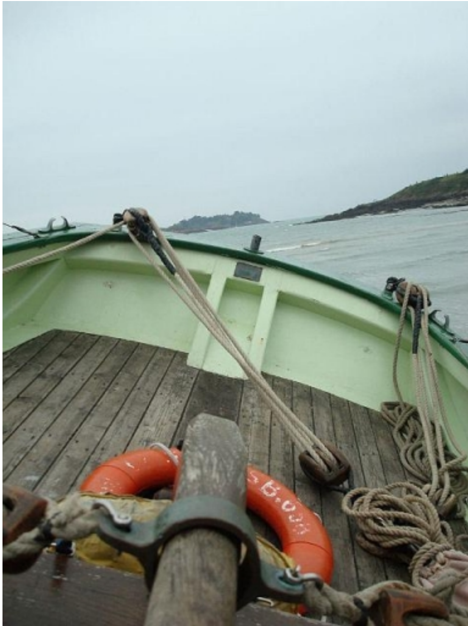
Vue du pont arrière et de la barre franche de gouvernail du 'Grand Léjon' (collection particulière, Association le Grand Léjon)
