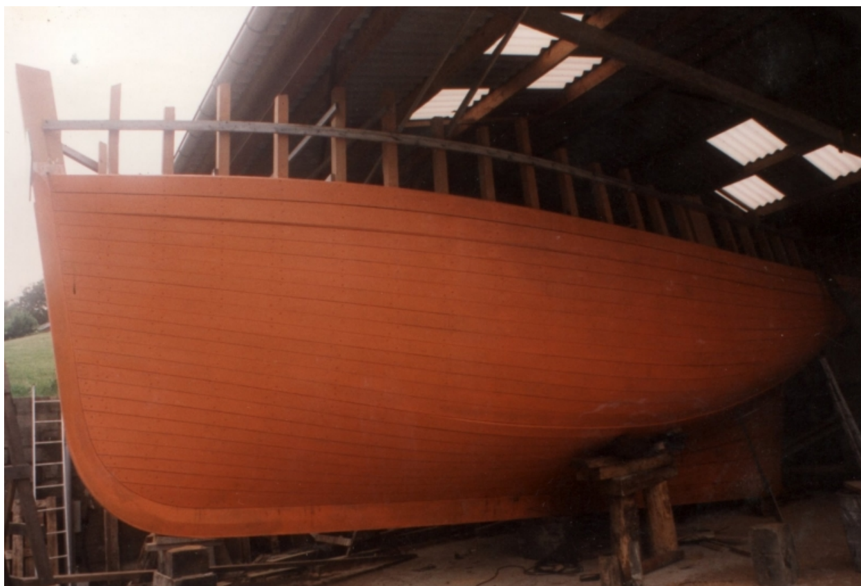
Vue de la coque entièrement bordée, sans le pavois (collection particulière, Association le Grand Léjon)
