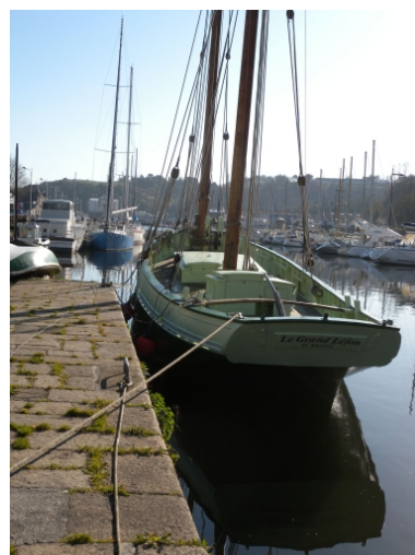
Vue du 'Grand Léjon' dans le port du Légué : remarquer la largeur de la coque, très épaulée et le tableau arrière avec sa courte voûte Phot. Guy Prigent IVR53_20082213347NUCA
