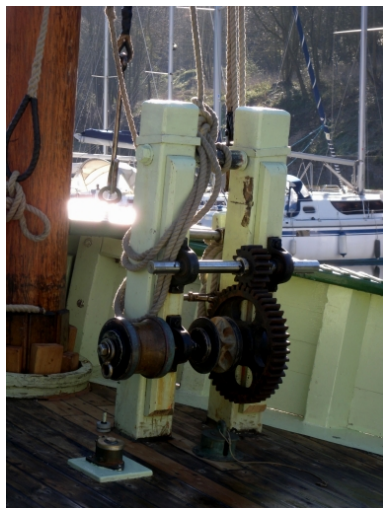
Vue du guindeau reconstitué sur le pont avant, avec les deux pignons et le barbotin Phot. Guy Prigent IVR53_20082213349NUCA
