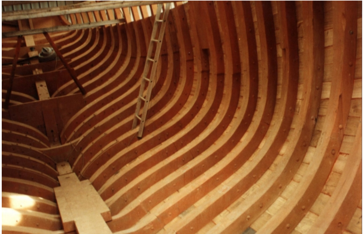
Vue de détail des membrures en chêne, de forte section (collection particulière, Association le Grand Léjon)
