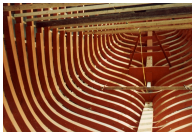
Vue de la charpente intérieure de la coque entièrement membrée et varangée, au chantier Clochet (collection particulière, Association le Grand Léjon) Repro. Guy Prigent, Autr. Stéphanie (auteur) Huet IVR53_20082213352NUCB
