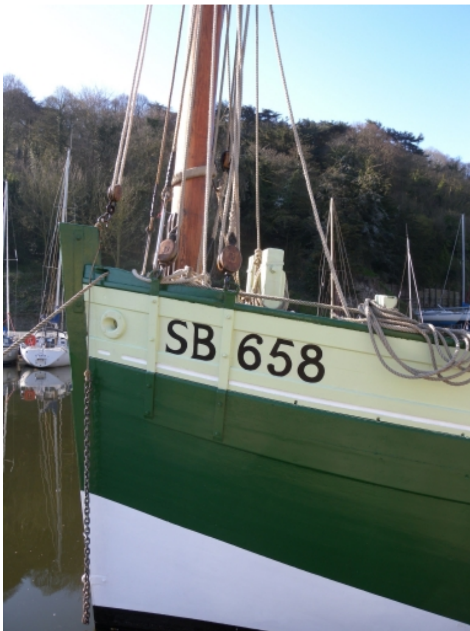
Vue de l'étrave à moustaches du 'Grand Léjon' : remarquer le haut franc-bord
