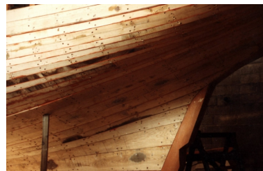
Vue de la coque en construction : remarquer la rablure droite et la largeur des bordés de galbord et de ribord (collection particulière, Association le Grand Léjon) Repro. Guy Prigent, Autr. Stéphanie (auteur) Huet IVR53_20082213355NUCB
