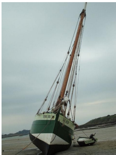
Vue du 'Grand Léjon', échoué sur le 'Grand Banc' dans une position confortable en raison de sa quille longue et de son bordé d'échouage (collection particulière, Association le Grand Léjon) Repro. Guy Prigent IVR53_20082213361NUCB
