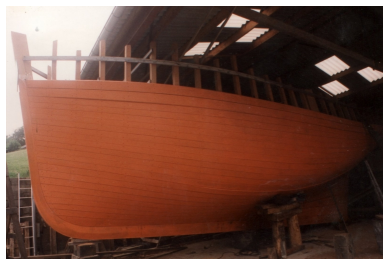
Vue de la coque entièrement bordée, sans le pavois (collection particulière, Association le Grand Léjon) Repro. Guy Prigent, Autr. Stéphanie (auteur) Huet IVR53_20082213363NUCB
