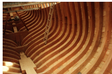
Vue de détail des membrures en chêne, de forte section (collection particulière, Association le Grand Léjon) Repro. Guy Prigent, Autr. Stéphanie (auteur) Huet IVR53_20082213353NUCB
