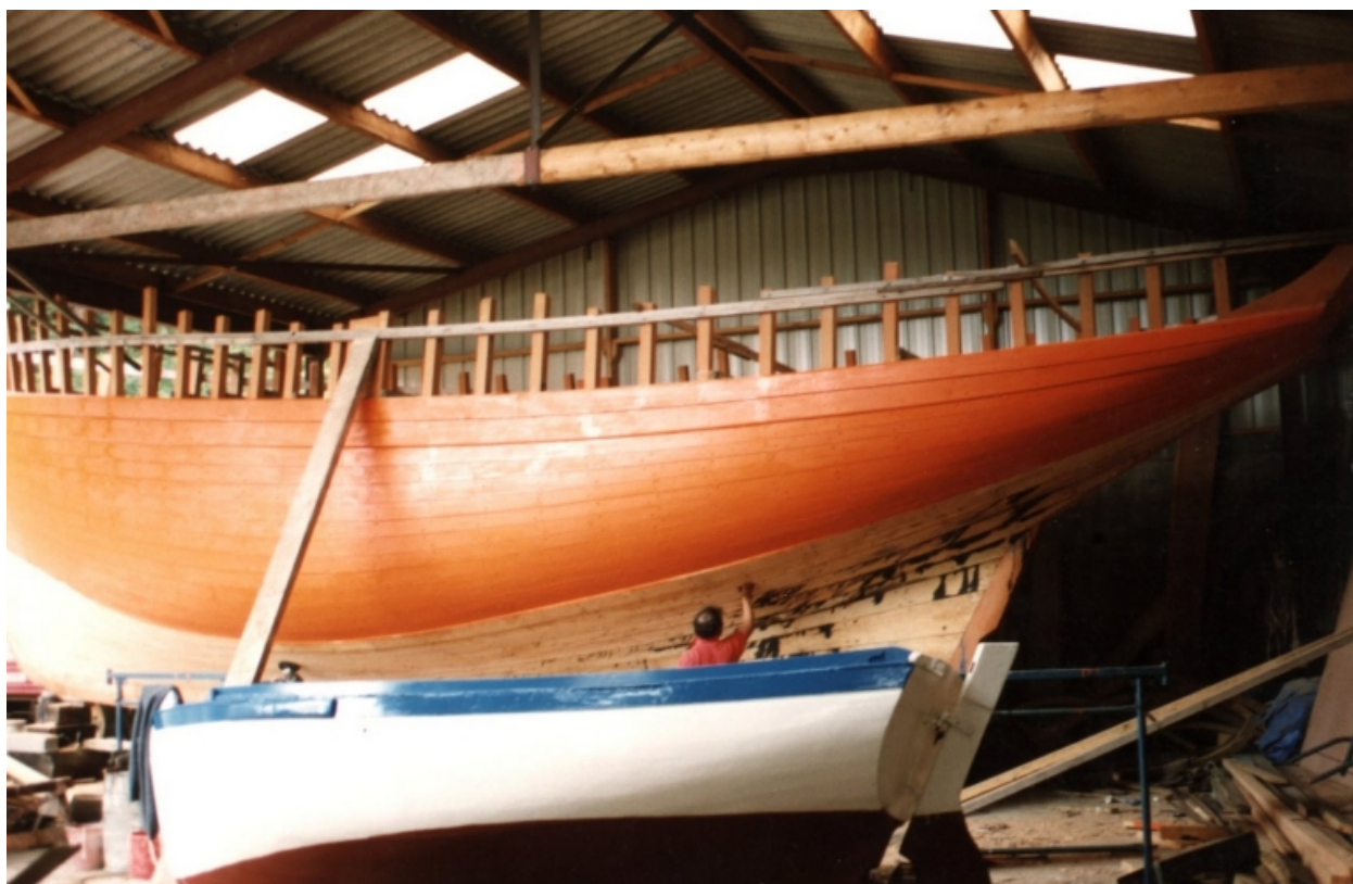
Opération de calfatage du Grand Léjon par Serge Riou, charpentier de marine (collection particulière, Association le Grand Léjon)
