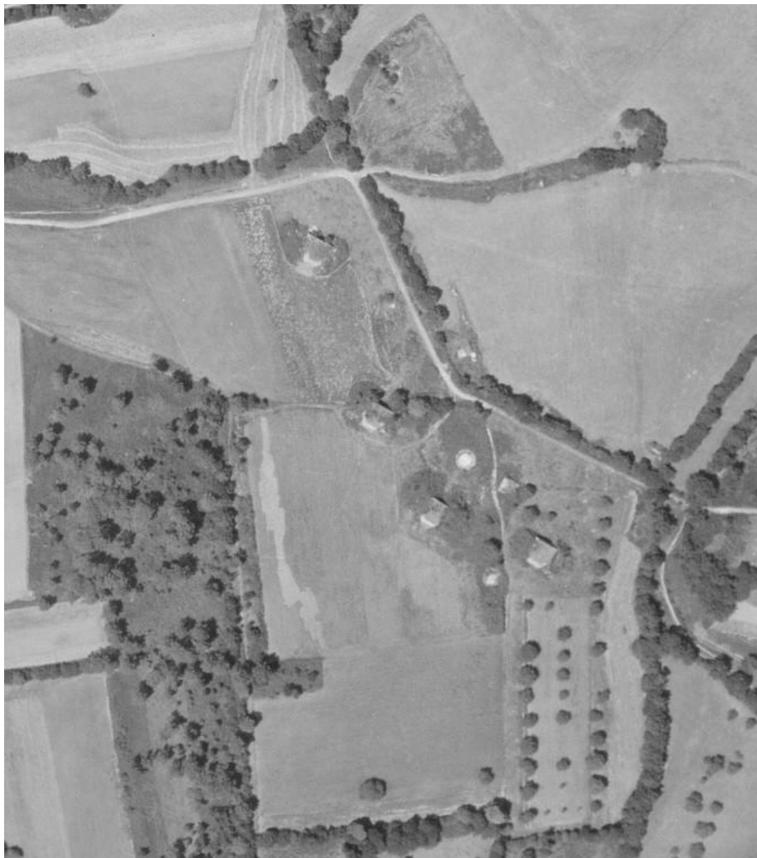
Vue aérienne verticale de la batterie d'artillerie de l'armée de terre (Lo 204) implantée à 500 m à l'est de la ferme du Cosquéric, 1955. Quatre bunkers-casemates de type 669 sont notamment visibles
