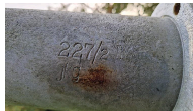
Vue du marquage sur le tube du canon contre avion Bofors de 40 mm : 227/2/U" suivi de "jKg" et d'un aile impérial stylisé combiné à une croix gammée. On semble lire le n°_829 Phot. Guillaume Lécueillier IVR53_20255632900NUCA
