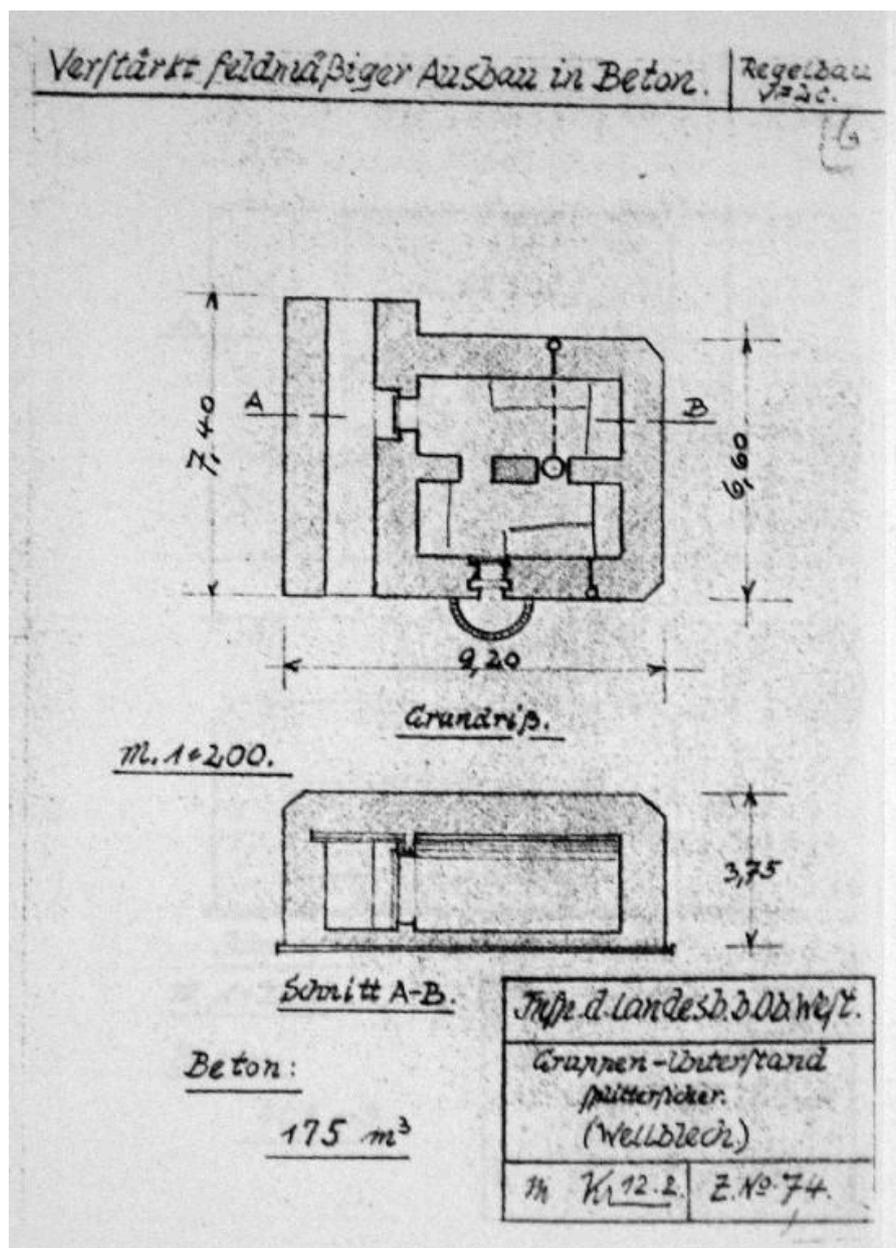
Plan d'un bunker - casemate de type VF 2c (Verstärkt feldmässiger Ausbau in Beton, Regelbau VF2c : Gruppen-Unterstand bis 12 Mann, Splittersicher [pare-éclats], Wellblech [tôle ondulée])
