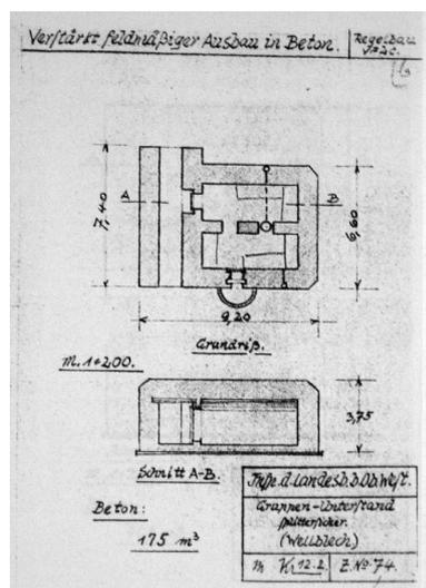
Plan d'un bunker - casemate de type VF 2c (Verstärkt feldmäßiger Ausbau in Beton, Regelbau VF2c : Gruppen-Unterstand bis 12 Mann, Splittersicher [pare-éclats], Wellblech [tôle ondulée])
