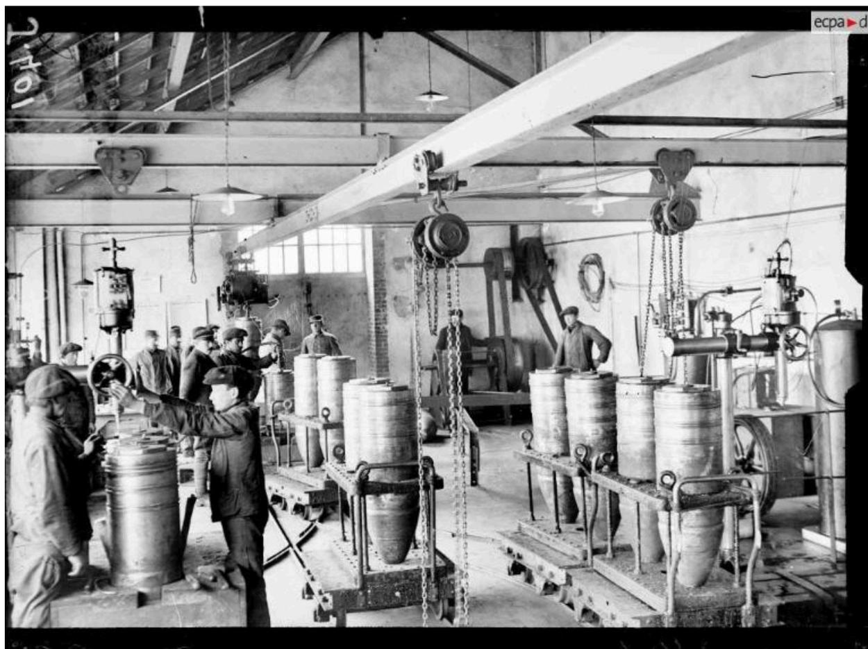
Vue intérieure d'un atelier en 1916 : vissage des bouchons sur des obus de 340 mm. L'équipe est masculine. Cet atelier à charpente métallique avec plusieurs treuils manuels est traversé par deux voies ferrées étroites et doté d'une plaque tournante
