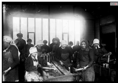
Vue intérieure d'un atelier en 1916 : lavage et nettoyage des obus de 75 mm après la coulée de mélinite et le tassage. L'équipe est très majoritairement féminine (le foulard protège les cheveux des salissures). Les murs de l'atelier sont carrelés
