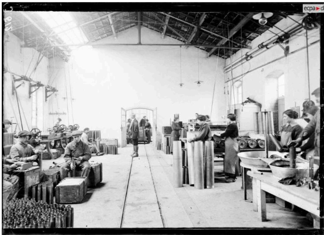
Vue intérieure d'un atelier en 1916 : vernissage des douilles et tournage. Cet atelier à charpente métallique et ouvertures en arc segmentaire est traversé par une voie ferrée étroite ; des poulies font fonctionner les machines
