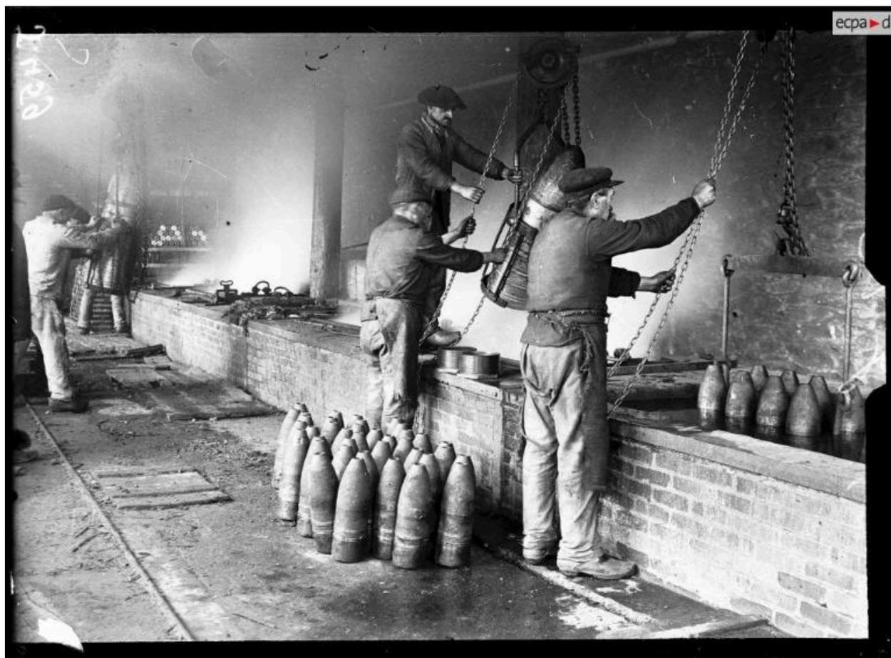
Vue intérieure d'un atelier en 1916 : obus sortant du bain d'huile (avant la coulée de mélinite). L'équipe est masculine. Cet atelier, équipé de treuils manuels, est traversé par une voie ferrée étroite sur laquelle circulent les chariots
