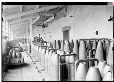
Vue intérieure d'un atelier en 1916 : préparation des obus de gros calibre. Ce long atelier couvert en appentis et éclairé par des fenêtres de type verrière est traversé par une voie ferrée étroite
