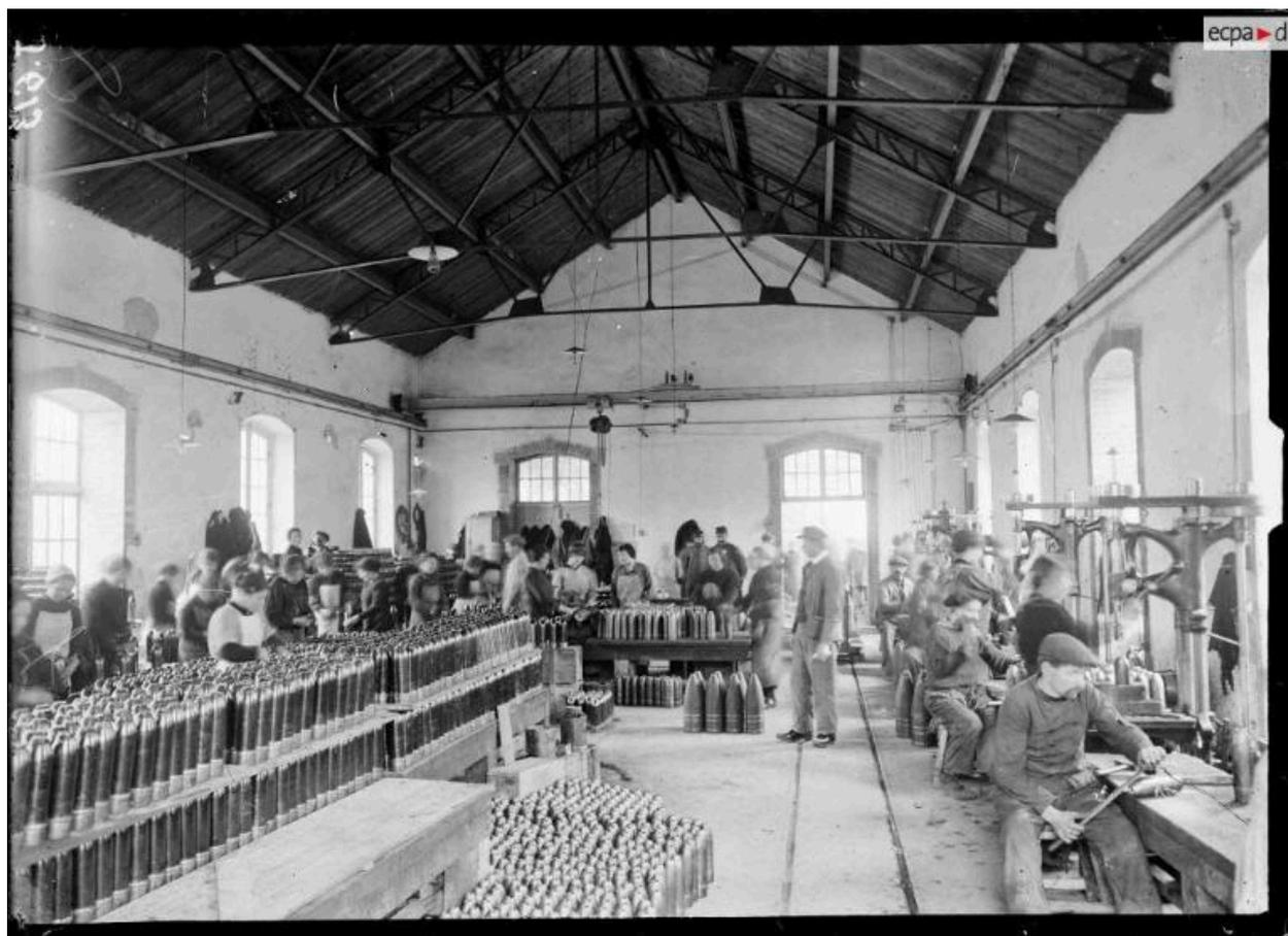
Vue intérieure d'un atelier en 1916 : à gauche, peinture des obus ; à droite, autre chaîne avec presses. Cet atelier à charpente métallique et ouvertures en arc segmentaire est traversé par deux voies ferrées étroites, il est doté d'un pont roulant manuel
