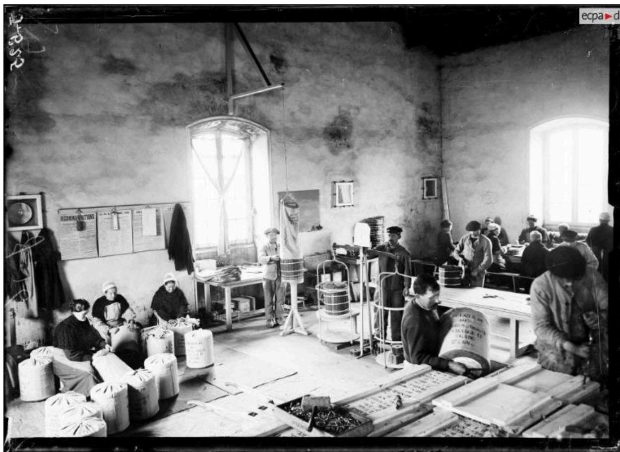
Vue intérieure d'un atelier en 1916 : confection des gargousses pour obusier de 400 mm (pesée, emballage, encaissage). Une potence sert à suspendre la toile lors de son remplissage. L'équipe est mixte. Dans le mur : dispositif d'éclairage
