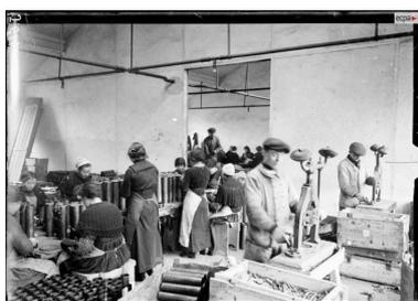
Vue intérieure d'un atelier en 1916 : amorçage, marquage et chargement des douilles de 75 mm. L'équipe est mixte. L'atelier est divisé par une cloison ; suspendu au plafond, un dispositif d'extinction incendie
