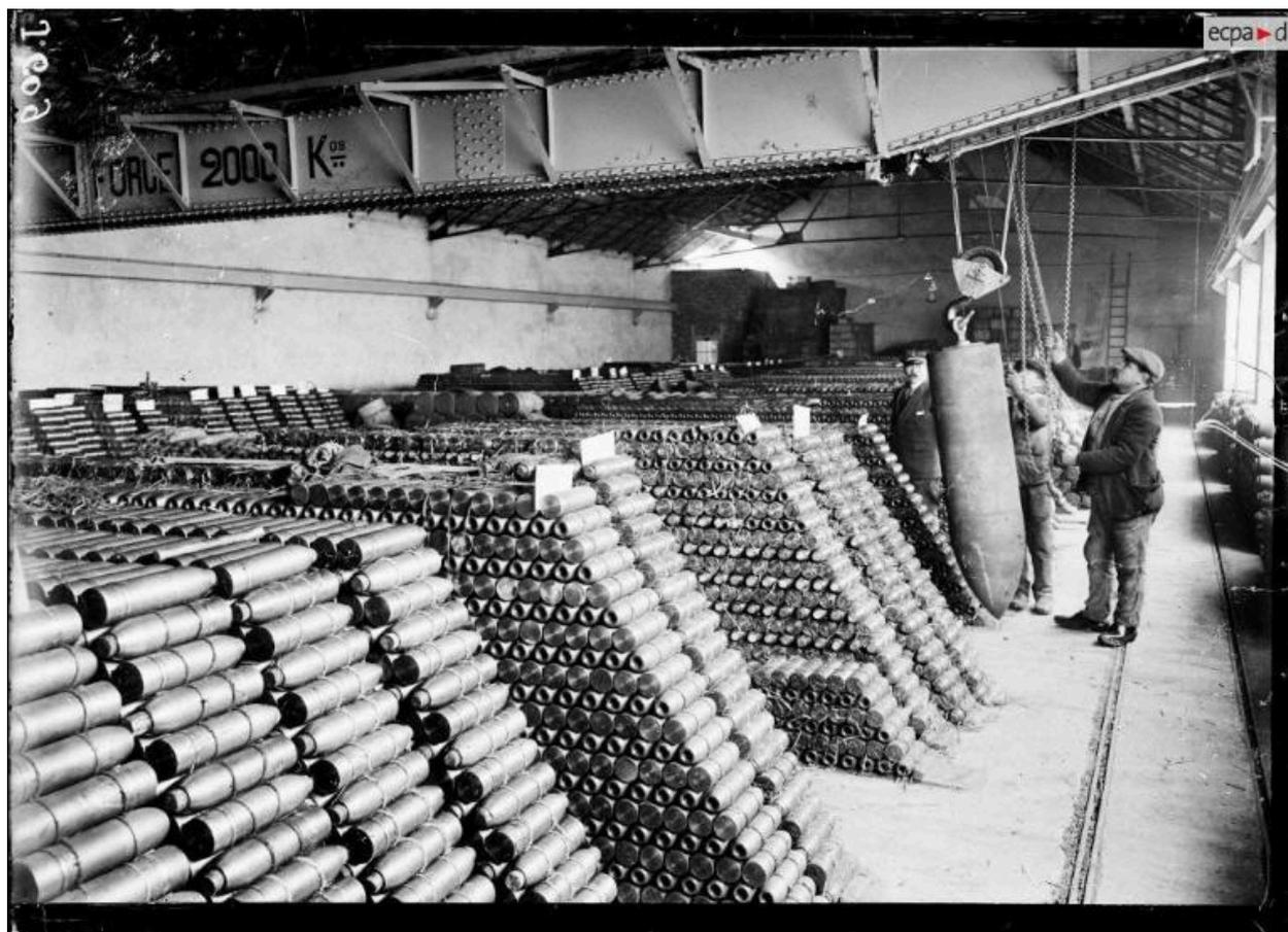
Vue intérieure d'un atelier en 1916 : stock d'obus de différents calibres. Cet atelier à charpente métallique, traversé par une voie ferrée étroite, est doté d'un pont roulant manuel d'une capacité de 2 t
