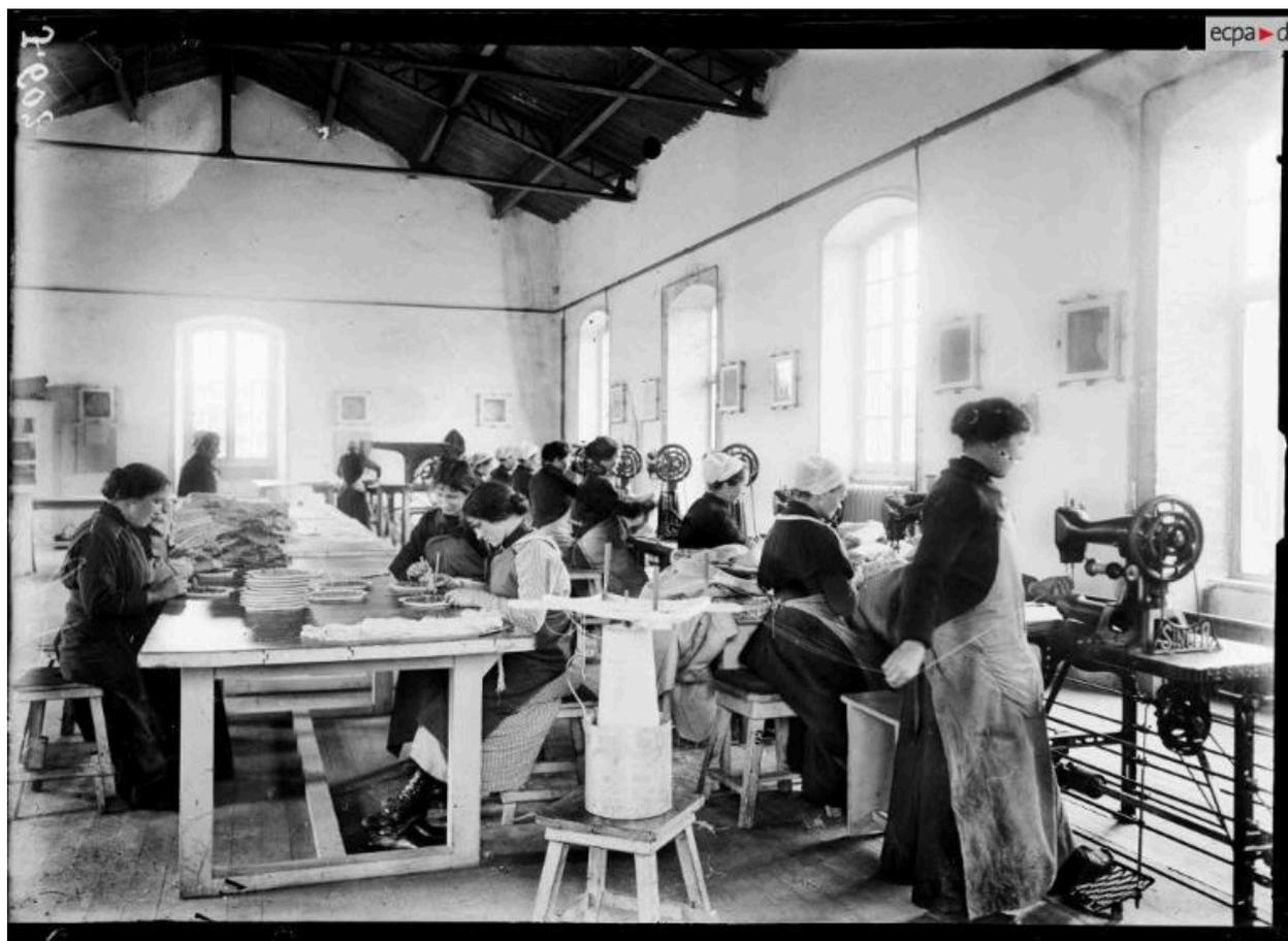
Vue intérieure d'un atelier en 1916 : confection des gargousses. A gauche, alignement de machines à coudre de marque Singer. L'équipe est féminine et dispose de tabourets. Cet atelier est à charpente métallique et ouvertures en arc segmentaire
