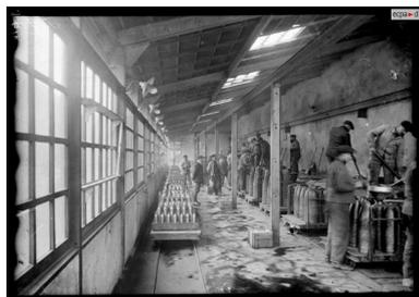
Vue intérieure d'un atelier en 1916 : à gauche, chariots chargés d'obus ; à droite, coulée de mélinite dans les obus. Ce long atelier à charpente métallique éclairé par des fenêtres de type verrière est traversé par deux voies ferrées étroites
