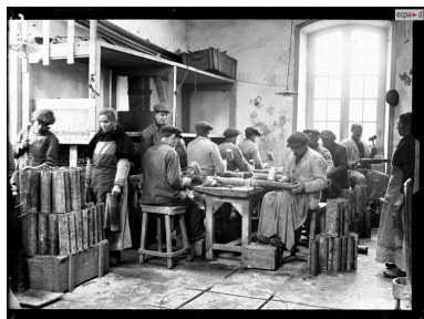
Vue intérieure d'un atelier en 1916 : débosselage des douilles au maillet sur une forme. L'équipe est mixte. Cet atelier est desservi par une voie ferrée étroite dotée d'une plaque tournante
