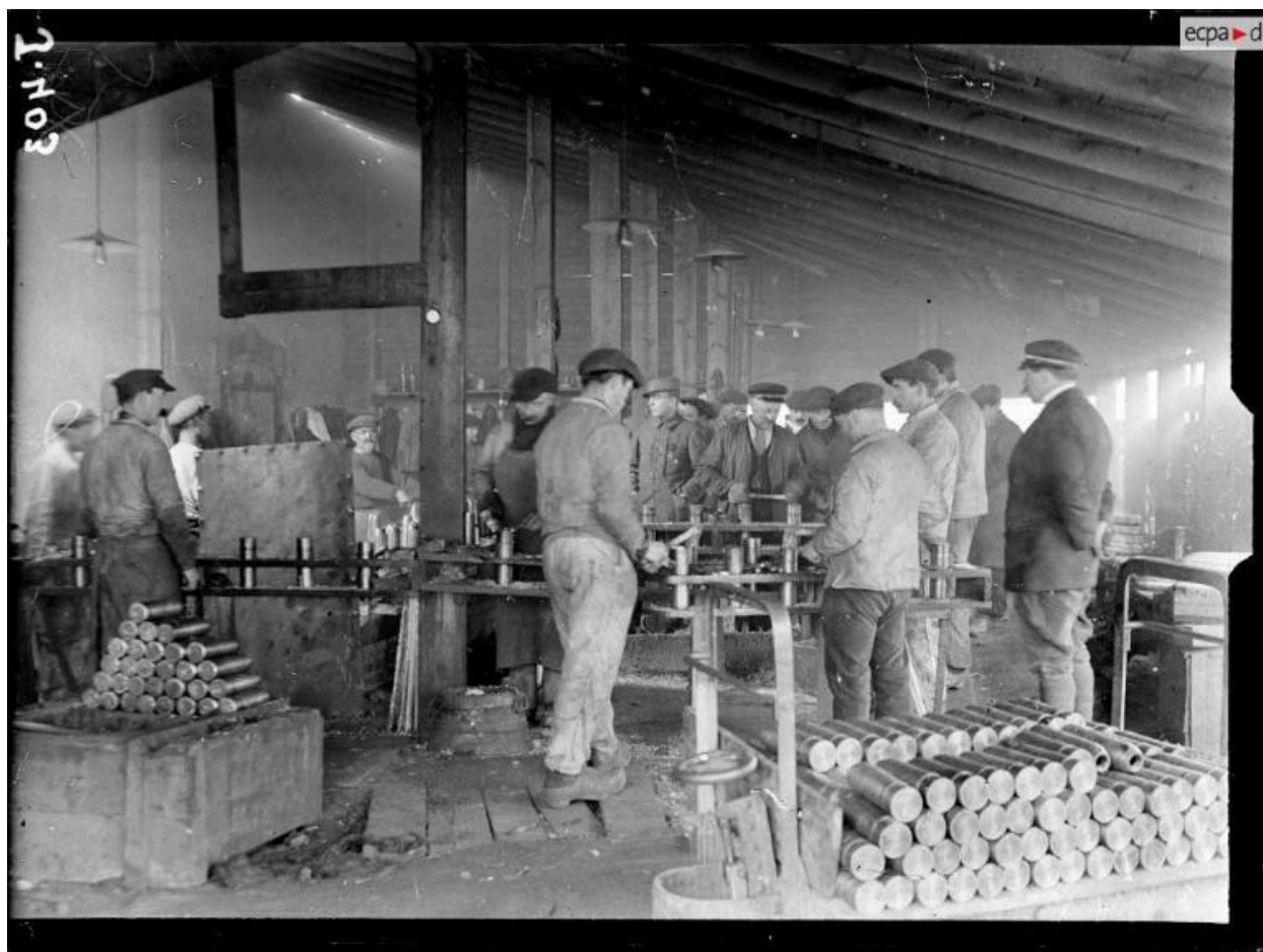
Vue intérieure d'un atelier en 1916 : chaîne d'obus de 75 mm. L'équipe est masculine. Cet atelier en bois est traversé par une voie ferrée étroite sur laquelle circulent les chariots (au premier plan à droite)
