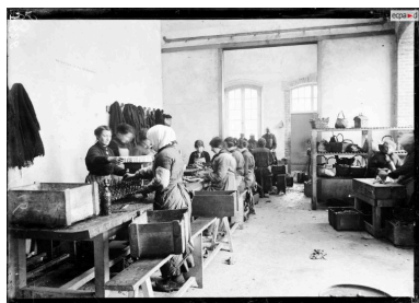
Vue intérieure d'un atelier en 1916 : une majorité de femmes est employée au nettoyage des gaines relais. Elles sont assises sur des bancs. A droite, étagère des paniers repas. L'atelier est doté d'ouvertures en arc segmentaire Repro. Auteur inconnu, Phot. Victor Dietsch IVR53_20252910312NUC
