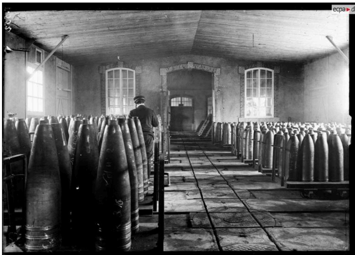
Vue intérieure d'un atelier en 1916 : obus de 340 mm en refroidissement après la coulée de mélinite. Cet atelier est traversé par une voie ferrée étroite dotée de ramifications desservies par des plaques tournantes
