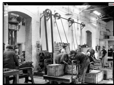
Vue intérieure d'un atelier en 1916 : mise en caisse des douilles. Cet atelier est traversé par une voie ferrée étroite, il est doté de plusieurs machines alimentées par un moteur électrique via des poulies et courroies. A gauche, la presse Saÿn-Paris de 1892
