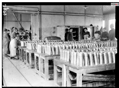
Vue intérieure d'un atelier en 1916 : vernissage des obus. L'équipe est féminine. Cet atelier est traversé par une voie ferrée étroite (au premier plan à droite) sur laquelle circulent les chariots
