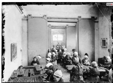
Vue intérieure d'un atelier en 1916 : une majorité de femmes est employée à la peinture au pinceau des fusées d'obus. L'atelier est coupé dans la longueur par des portes coulissantes métalliques ; il est doté d'une porte à linteau en arc segmentaire Repro. Auteur inconnu, Phot. Victor Dietsch IVR53_20252910313NUC
