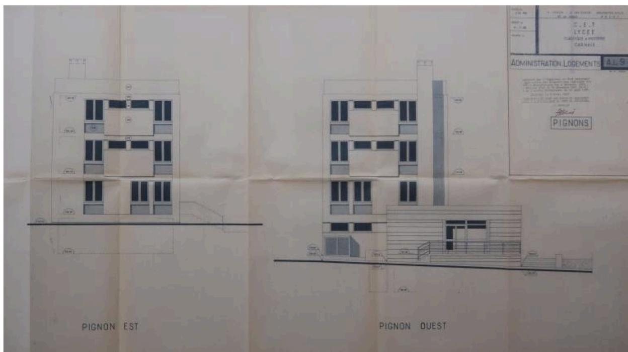
Elévation des pignons du bâtiment "administration - logements" : administration. Noter l'adaptation à la déclivité du terrain, avec une loge au niveau des sous-sol du reste du bâtiment. Hervé Péron et Alexandre Weisbein, architecte, 1965.
