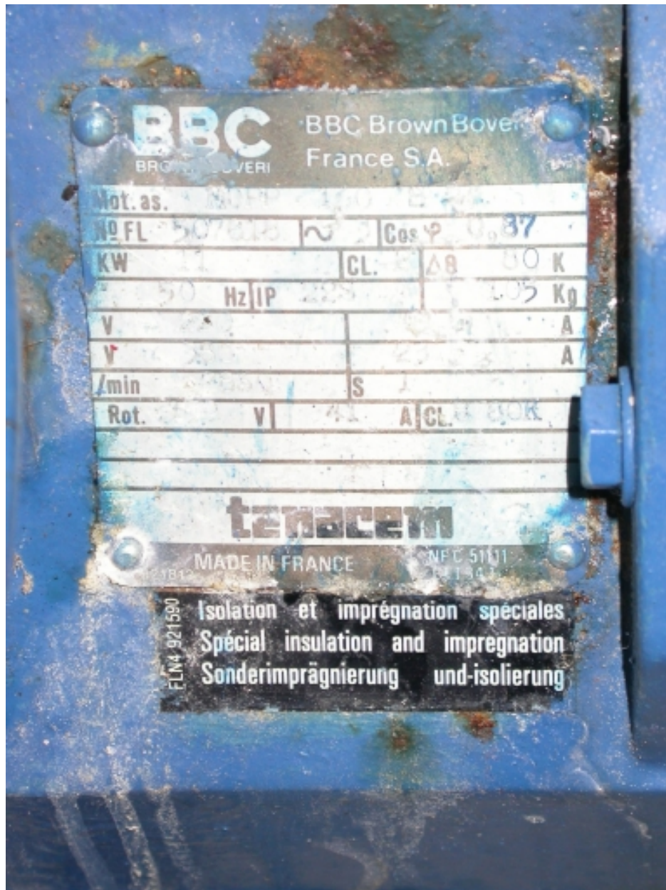
Inscription technique du moteur asynchrone.
