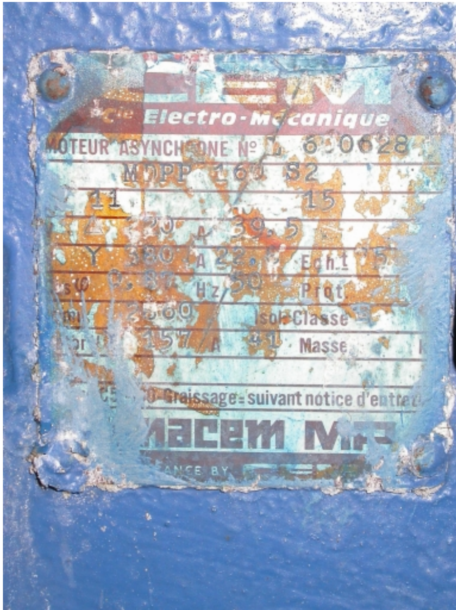
Plaque de constructeur d'un des deux moteurs électriques : Compagnie Electro-Mécanique (CEM).
