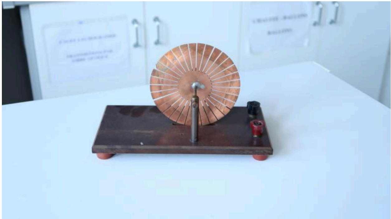
Un élément des collections pédagogiques : roue de Barlow.
