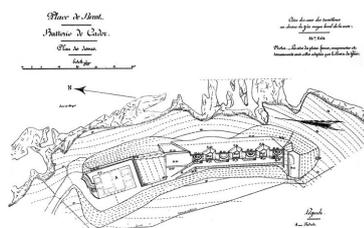
Plan de la batterie et du réduit de Beg Ar Gador ou pointe du Kador (4 canons de 95 mm)
