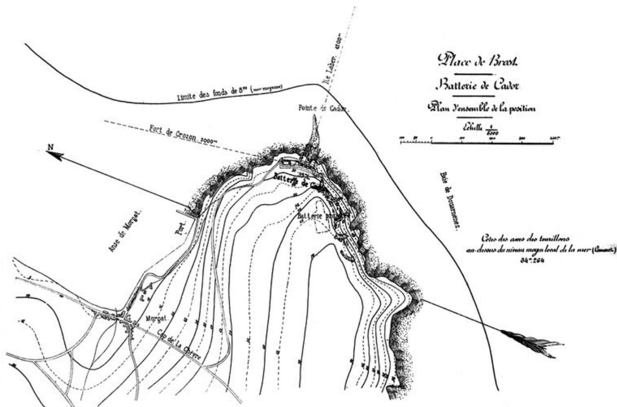
Plan de situation de la batterie de Beg Ar Gador ou pointe du Kador (4 canons de 95 mm)
