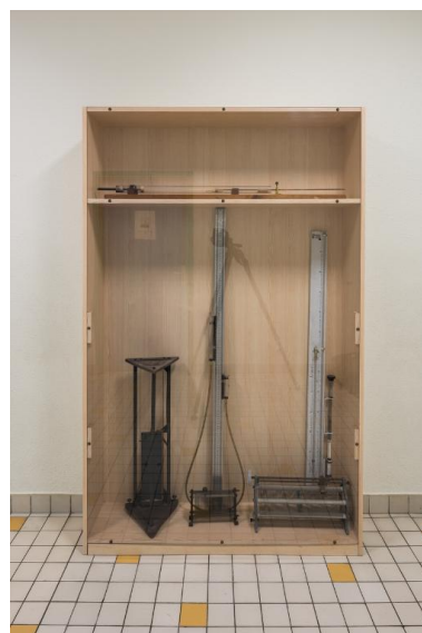
Une partie des collections pédagogiques : tube de Kundt (?), appareil chute libre d'une plaque, rhéostats. Phot. Delia Gaulin-Crespel IVR53_20193501541NUCA
