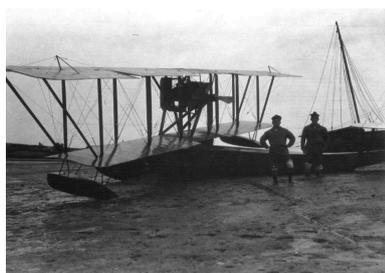
Hydravion biplan FBA 150 hp type H sur la grève à marée basse
