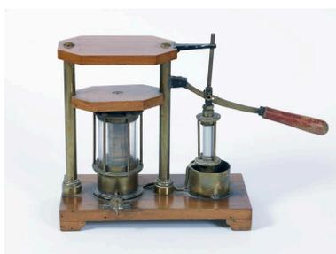
Presse hydraulique - Hydrostatique-
