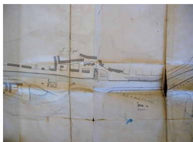
Avant-projet du bassin à flot en 1839 : remarquer le gril de carénage, la cale de construction et les deux cales du quai de l'Aiguillon (AD 22) Repro. Guy Prigent IVR53_20082212898NUCB
