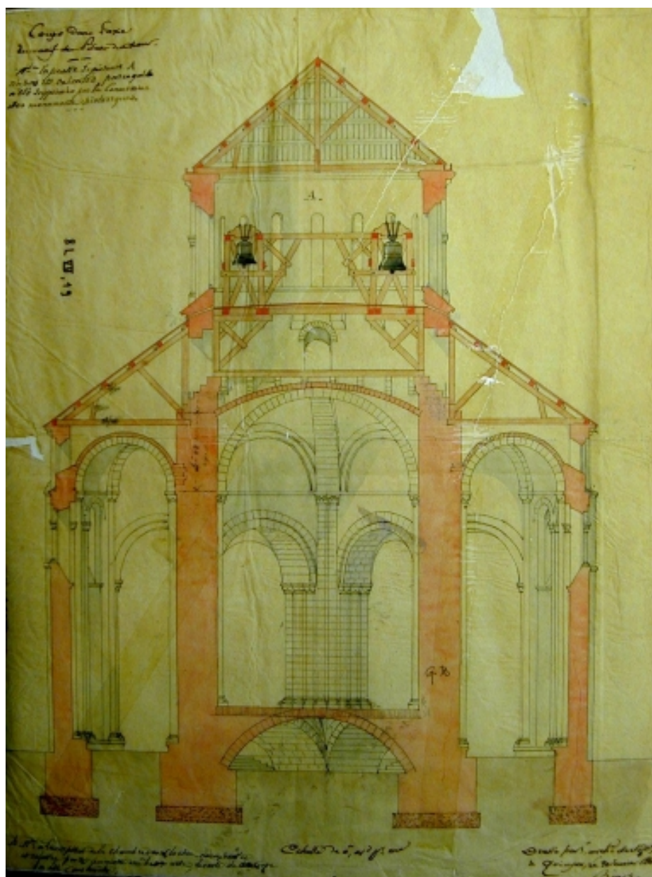
Quimperlé, église paroissiale Sainte-Croix : coupe dans l'axe du massif des piliers du choeur et chambre des cloches. Partie A : non réalisée. Dessin Gustave Bigot, vers 1864-1866 (A.E. Quimper, Fonds Bigot), reproduction de 2004
