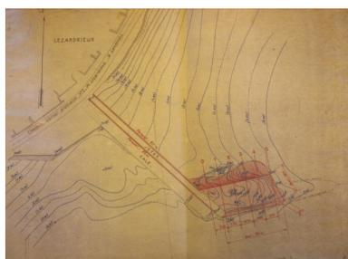
Plan, avant-projet : construction d'un quai et d'un terre-plein à l'extrémité de la jetée, 1924 (AD 22)
