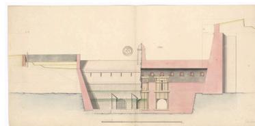
Coupe et élévation d'une écluse à trois portes destinée à l'alimentation d'un fossé en eau du fort projeté sur la hauteur de la batterie de Cornouaille à l'entrée du Goulet de Brest. 1684 (?), auteur inconnu mais supervisé par Vauban
