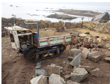
Utilisation d'un transporteur à chenilles (collection particulière) Phot. Guy Prigent, Autr. Nicole Bihan IVR53_20072205701NUCB
