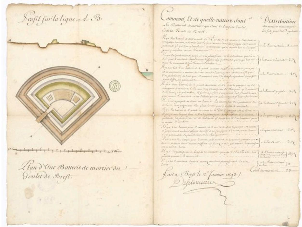
Profil et plan type d'une batterie de mortier du Goulet de Brest avec un état des batteries de mortier qui défendent cette rade, fait à Brest le 2 janvier 1693 par Champy Desclouzeaux, intendant de Brest de 1683-1701
