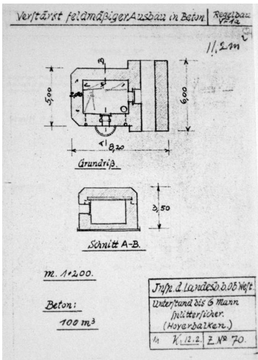
Plan d'un bunker - casemate de type VF1a (Verstärkt feldmäßiger Ausbau in Beton, Regelbau VF1a : Unterstand bis 6 Mann, Splittersicher [pare-éclats], Hoyerbalken [poutres Hoyer])
