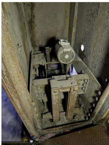
Vue intérieure de l'un des deux volets de la porte blindée nord : système motorisé permettant le blocage de la porte
