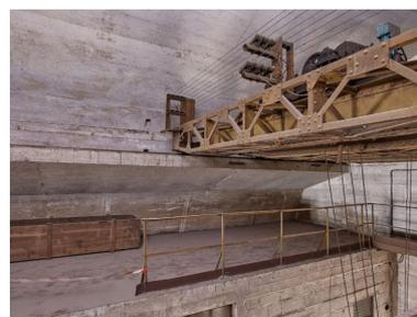
Vue de détail du pont roulant arrière doté de ses deux treuils (pont roulant de la période allemande)
