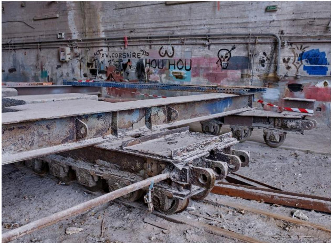
Vue d'une partie du ber du slipway sur ses quatre rails. Ici, un point de raccordement du ber
