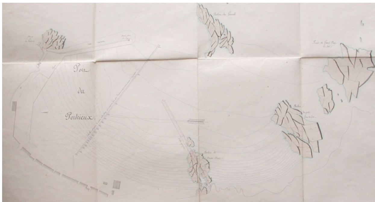
Plan : jetée existante à l'ouest à la pointe de la Batterie et jetée projetée à l'est sur le rocher du Tertre Denis, 1854 (AD 22)
