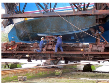
Première vérification : s'assurer de la stabilité du bateau sur ses patins Phot. Erwana L'Haridon IVR53_20162906108NUCA
