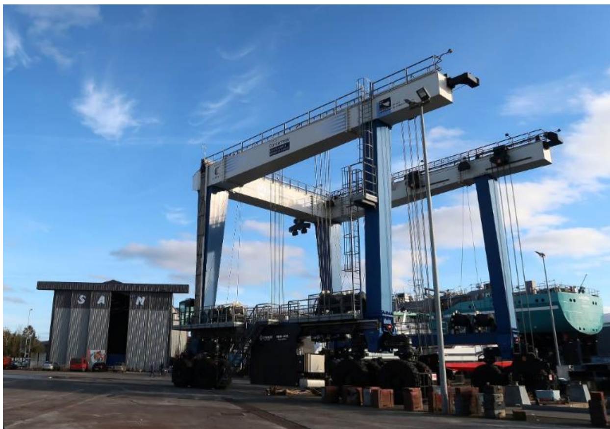
Elévateur à sangles d'une capacité de 400 tonnes inauguré en 2018
