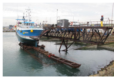
Sortie de l'eau : la passerelle recule vers le slipway, le bateau est posé et maintenu sur le chariot Phot. Erwana L'Haridon IVR53_20162906106NUCA
