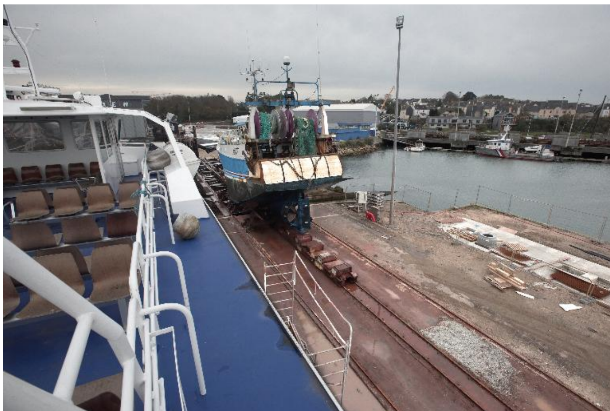
Manoeuvre en cours : chariot sur rails
