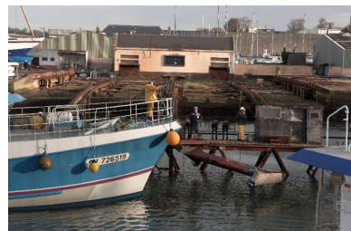
Bateau de pêche se positionnant pour être parallèle à la passerelle et centré pour être bloqué par le bras. Phot. Bernard Bègne IVR53_20162900599NUCA
