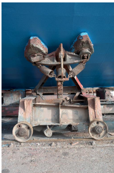
Ber, patins, vue rapprochée Phot. Bernard Bègne IVR53_20162900628NUCA
