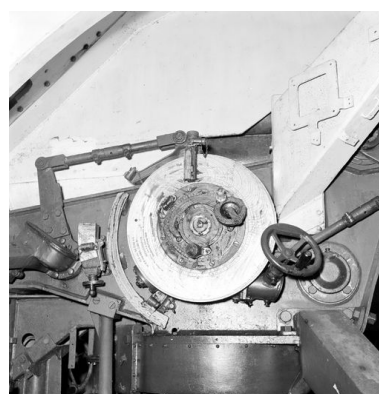
Vue de l'un des quatre canons antiaériens de 10,5 cm sous blindage : disque de hausse gradué (état en 1969) Phot. Guy Artur IVR53_19692900095X
