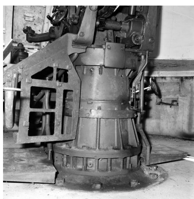
Vue de l'un des quatre canons antiaériens de 10,5 cm sous blindage : pivot (état en 1969) Phot. Guy Artur IVR53_19692900096X
