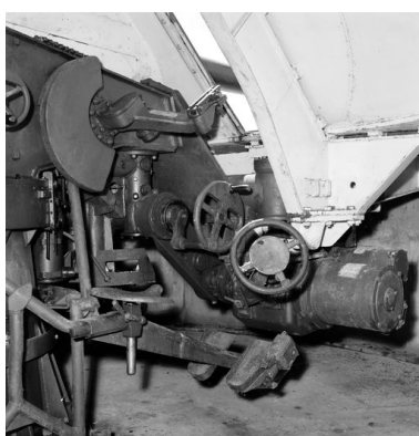
Vue de l'un des quatre canons antiaériens de 10,5 cm sous blindage : système de pointage (état en 1969) Phot. Guy Artur IVR53_19692900094X
