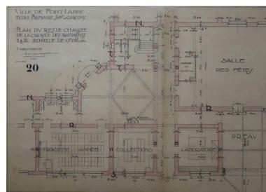
Plan du rez-de-chaussée de la croisée des bâtiments. G-R. Lefort, architecte, mars 1925. A l'ouest, les salles de classe, à l'est, la salle des fêtes. Noter la présence d'une salle de collections et d'un laboratoire, ainsi que l'aménagement de vestiaires dans le dégagement des salles de classes. Autr. Georges-Robert Lefort IVR53\_20222905196A0
