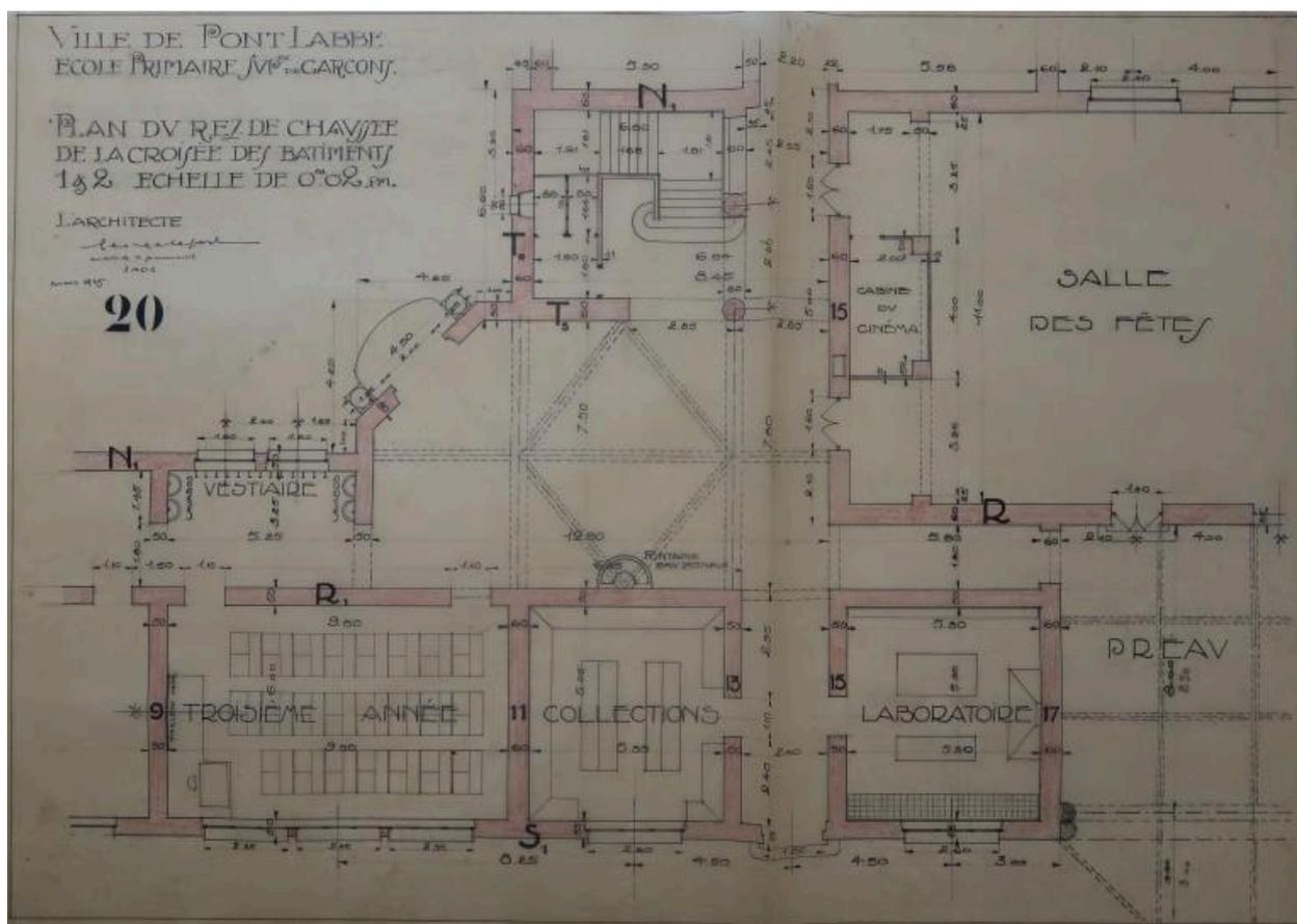
Plan du rez-de-chaussée de la croisée des bâtiments. G-R. Lefort, architecte, mars 1925. A l'ouest, les salles de classe, à l'est, la salle des fêtes. Noter la présence d'une salle de collections et d'un laboratoire, ainsi que l'aménagement de vestiaires dans le dégagement des salles de classes.
