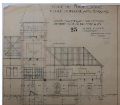
Coupe transversale sur le vestibule d'entrée. G-R. Lefort, architecte, mars 1925. Noter la présence, dans le campanile, d'un réservoir d'eau en ciment armé. Autr. Georges-Robert Lefort IVR53\_20222905197A0
