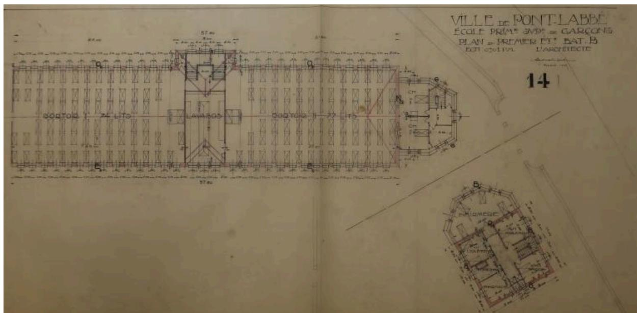
Plan du premier étage de l'aile nord et de l'infirmerie. Plan d'ensemble. G-R. Lefort, architecte, mars 1925. Deux dortoirs, lavabos, étage de l'infirmerie. Noter également l'escalier, un tiers hors-d'œuvre.
