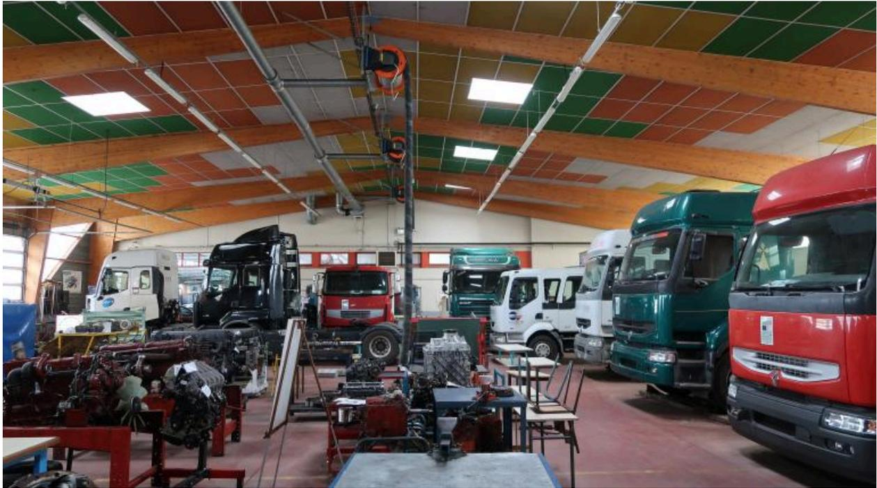
Vue intérieure de l'atelier mécanique camion. Il est implanté dans une extension des ateliers d'origine. Noter la structure porteuse en bois lamellé-collé.
