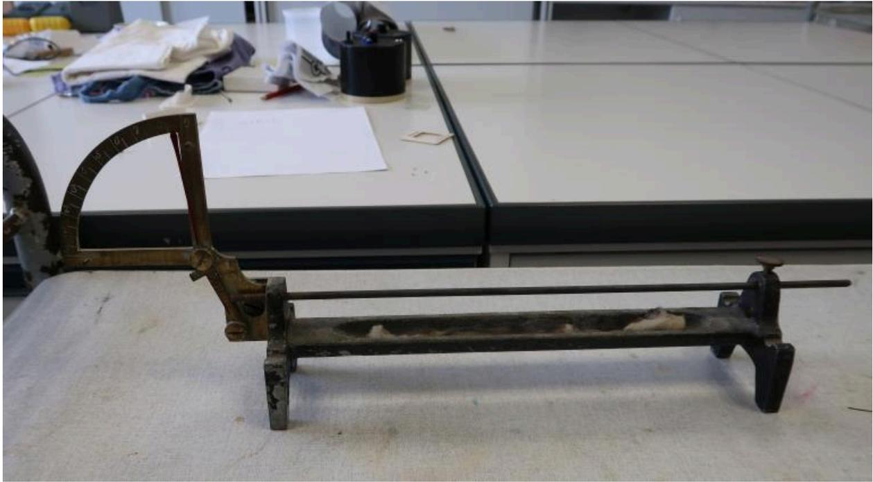
Collections pédagogiques du lycée : pyromètre à cadran (ou à levier) appelé aussi dilatomètre. Il est utilisé pour rendre visible le phénomène de dilatation linéaire des métaux.
