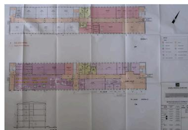
Restructuration de l'externat, plans du rez-de-chaussée et du 1er étage et coupe. AUA architectes, 2011. Noter la création, au rez-de-chaussée, d'un espace élèves, avec CDI, administration de la vie scolaire...
