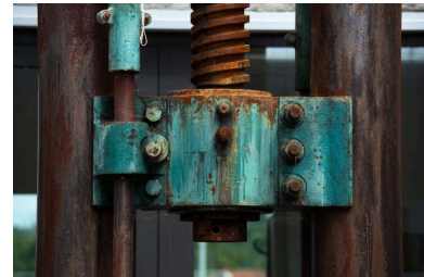
Vue de détail : porte-outil avec son logement de gaine de vis et la bouterolle (état en 2025) Phot. Léna Leroy IVR53_20252901196NUCA
