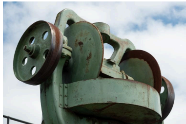
Vue de détail de la partie haute (état en 2025). On reconnaît les deux poulies de commande actionnant les arbres des plateaux de friction Phot. Léna Leroy IVR53_20252901194NUCA
