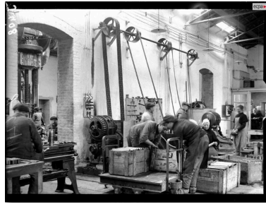
Vue intérieure d'un atelier en 1916 : mise en caisse des douilles. Cet atelier est traversé par une voie ferrée étroite, il est doté de plusieurs machines alimentées par un moteur électrique via des poulies et courroies. A gauche, la presse Saÿn-Paris de 1892 Repro. Auteur inconnu, Phot. Victor Dietsch IVR53_20252910288NUC
