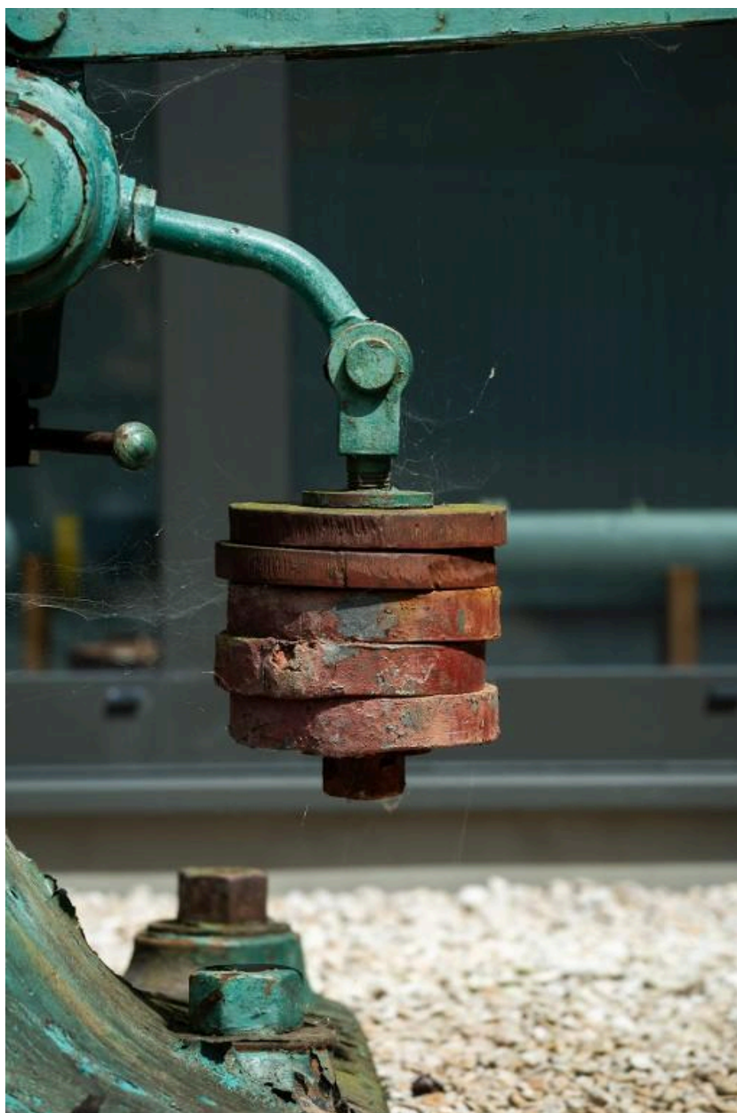
Vue de détail : contrepoids du levier de manoeuvre (état en 2025)
