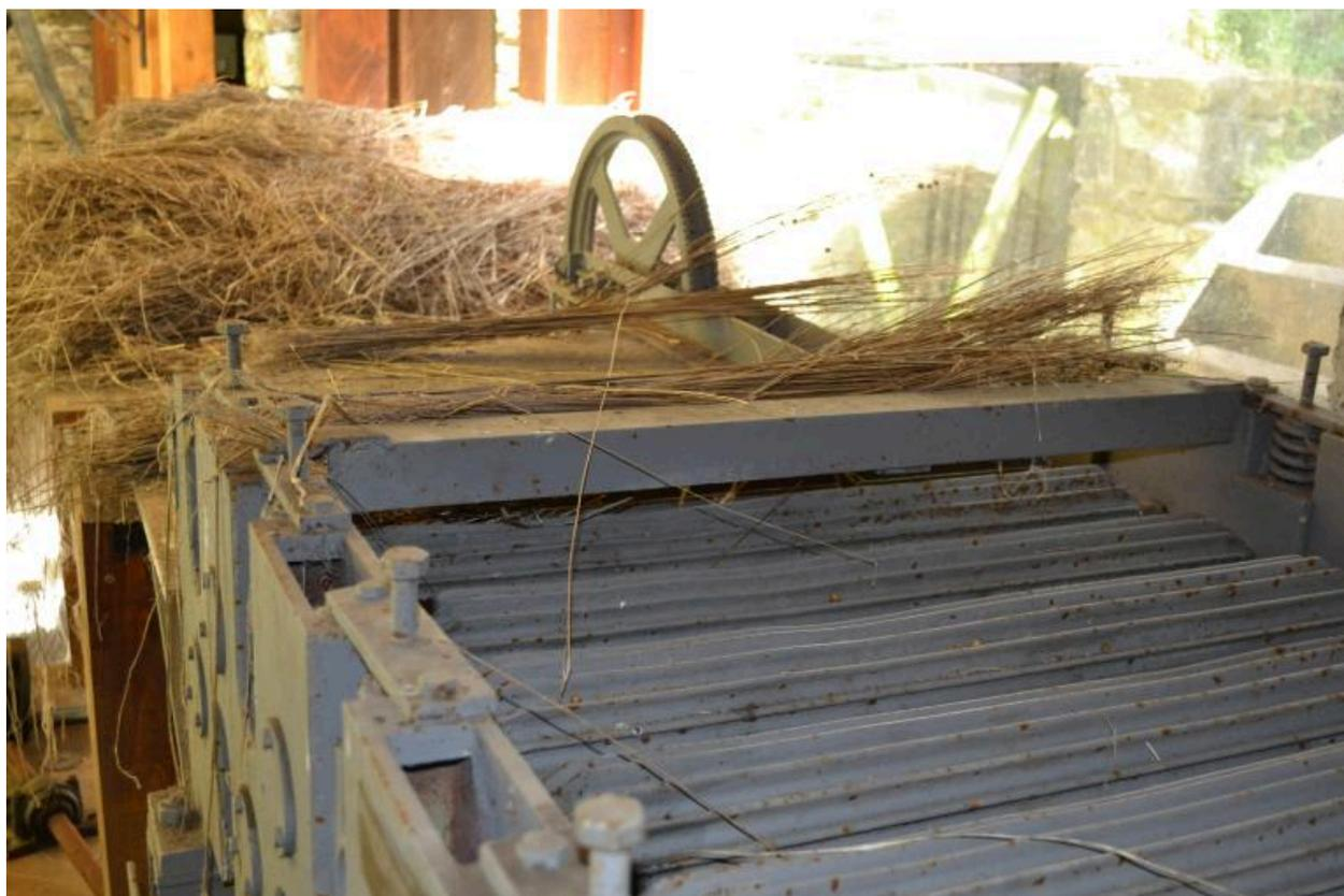
Broyeur du teillage mécanique - 1ère étape
