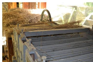
Broyeur du teillage mécanique - 1ère étape
