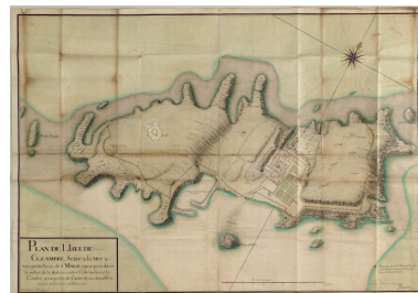
Plan de de l'Île de Cézembre par l'ingénieur Picot, non daté (contresigné par l'ingénieur Gareageau le 6 avril 1695). On voit notamment, lavé de couleur jaune : le projet de construction d'une tour-fanal à l'ouest et de trois batteries Phot. Picot, Repro. Service Historique de la Défense IVR53_20263510322NUCA
