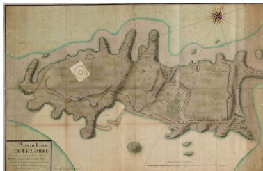
Plan de de l'Île de Cézembre par l'ingénieur Picot, 1694. On voit notamment, lavé de couleur jaune : le projet de construction d'une tour-fanal à l'ouest et de trois batteries d'artillerie Phot. Picot, Repro. Service Historique de la Défense IVR53_20263510319NUCA
