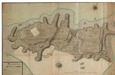
Plan de l'Île Cézembre par l'ingénieur Picot, 1694. On voit notamment, lavé de couleur jaune : le projet de construction d'une tour-fanal à l'ouest et de trois batteries d'artillerie Phot. Picot, Repro. Service Historique de la Défense IVR53_20263510319NUCA
