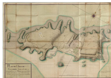
Plan de l'Île Cézembre par l'ingénieur Picot, non daté (contresigné par l'ingénieur Garengneau le 6 avril 1695). On voit notamment, lavé de couleur jaune : le projet de construction d'une tour-fanal à l'ouest et de trois batteries d'artillerie Phot. Picot, Repro. Service Historique de la Défense IVR53_20263510322NUCA
