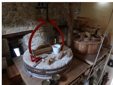
Loguivy-Plougras, le bourg : Moulin à eau de Traou an Dour, détail des deux meules sur la plate-forme (potence permettant le levage de la meule) Phot. Guillaume Lécueillier IVR53_20192205298NUCA
