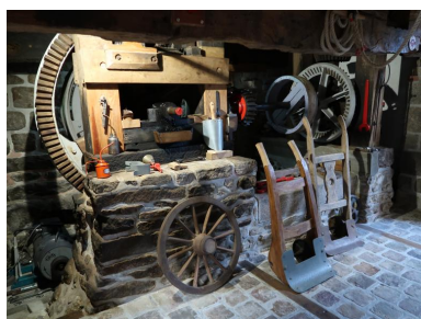
Loguivy-Plougras, le bourg : Moulin à eau de Traou an Dour, détail des mécanismes de transmission (arbre de la roue et rouet à alluchons) Phot. Guillaume Lécueillier IVR53_20192205295NUCA
