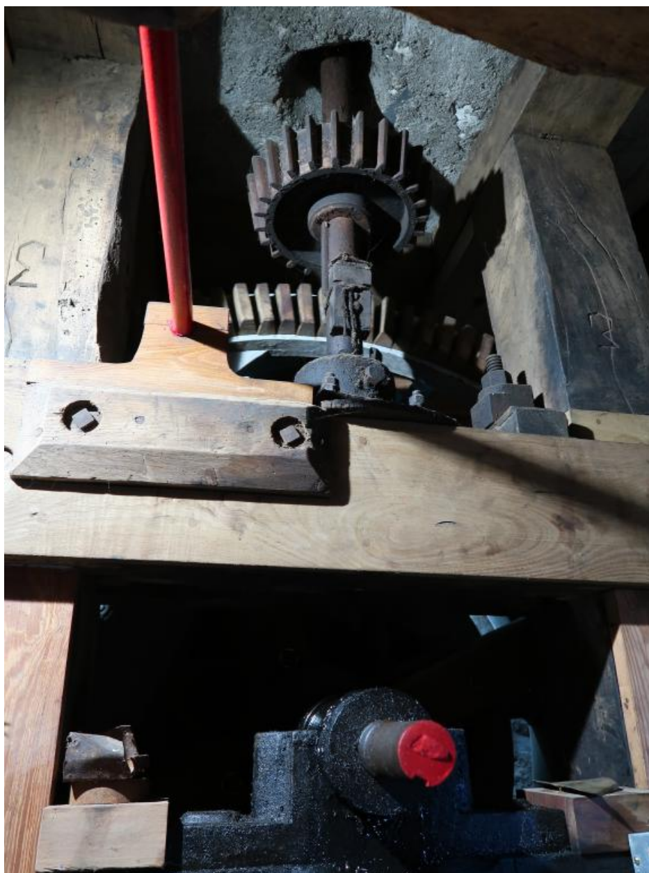
Loguivy-Plougras, le bourg : Moulin à eau de Traou an Dour, détail des mécanismes de transmission (arbre de la roue, rouet à alluchons)
