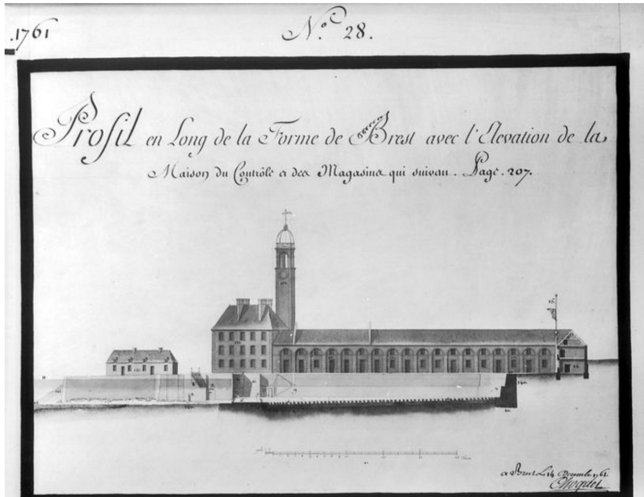
Profil en long de la forme de Brest avec l'élévation de la maison de contrôle et des magasins qui suivent, à Brest le 14 décembre 1761 par Choquet
