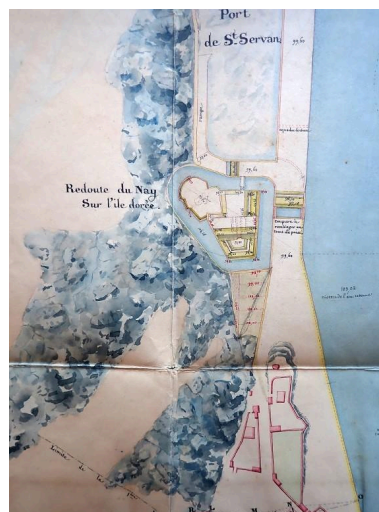
Extrait du projet des ouvrages de fortifications relatifs au bassin à flot entre les villes de Saint-Malo et Saint-Servan, 1838. Les parties lavées de jaune sont au stade de projet Repro. Lionel Duigou IVR53_20263510047NUCA
