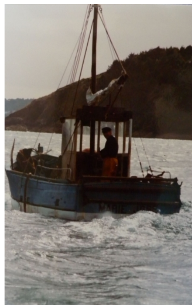
Vue du bateau sortant du Légué, 3ème quart 20ème siècle : remarquer la barre franche, le rouleau pour la pêche arrière et le vire-casiers sur les côtés (collection particulière) Repro. Guy Prigent IVR53_20082213150NUCB
