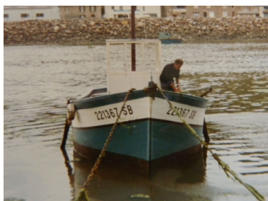
Vue des formes de l'avant : remarquer l'étrave un peu tulipée et bien défendue (collection particulière) Repro. Guy Prigent IVR53_20082213151NUCB
