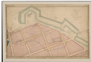
Section A de l'Harteloire : nouvelle enceinte, projet de quartier et voirie ; réseau de distribution d'eau, fait à Brest le 22 juillet 1848 par l'architecte Voyer signé par Pouliquen ; vu au Conseil Général des bâtiments civils à Paris le 12 mars 1849 Repro. Archives municipales et communautaires. Brest Métropole Océane, Autr. architecte. Auguste Pouliquen Voyer IVR53_20082909094NUCA
