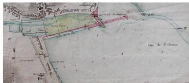
Plan : prolongement de l'estacade jusqu'à 100 m de distance du môle de Penthièvre, avec le projet de bassin dans l'ancien port, 1892 (AD 22)
