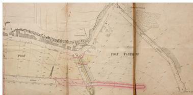
Plan daté de 1894 : prolongement de l'estacade, digue de protection de l'avant-port, coupure dans la vieille jetée et musoir (AD 22)
