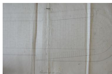
Plan détail appareil du musoir : élévation du côté intérieur de la jetée du Linkin, 1852 (AD 22)
